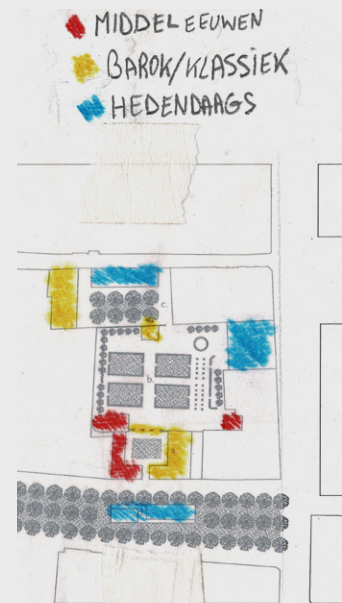
Afb. 4.3.9. Bovenste schema is van april, onderste schema is van juni. Het eerste idee was om het bezoekerscentrum te laten resoneren met Rubens' barokke architectuur omdat beide een belangrijke representatieve rol spelen op de site. Het paviljoen daarentegen zou aansluiten bij de bakstenen middeleeuwse gebouwen. De onderste schets toont het finale concept.
