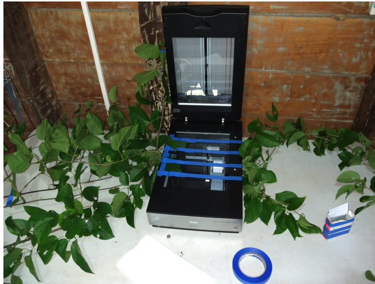
Figuur 3.4: Eén blad per tak en in totaal drie bladeren werden in een ontspannen houding met tape vastgemaakt op de scanner, opdat bladeren zo weinig mogelijk mechanische stress ondervinden.
