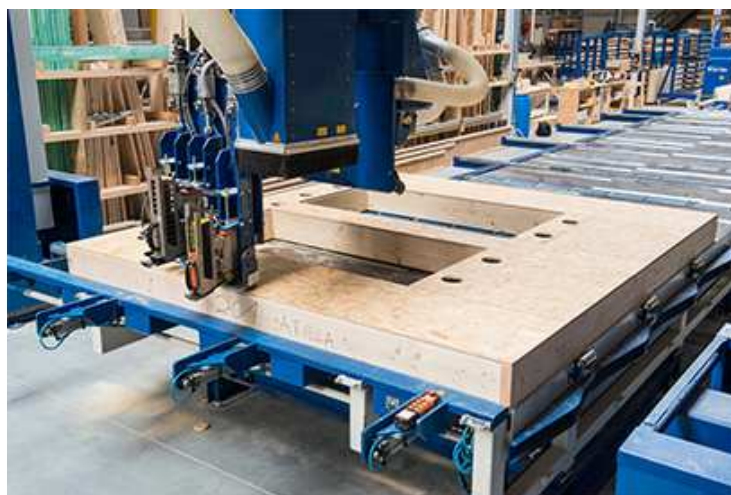
Figuur 15: Opbouw open houtskeletpaneel (Dupac,2021)
