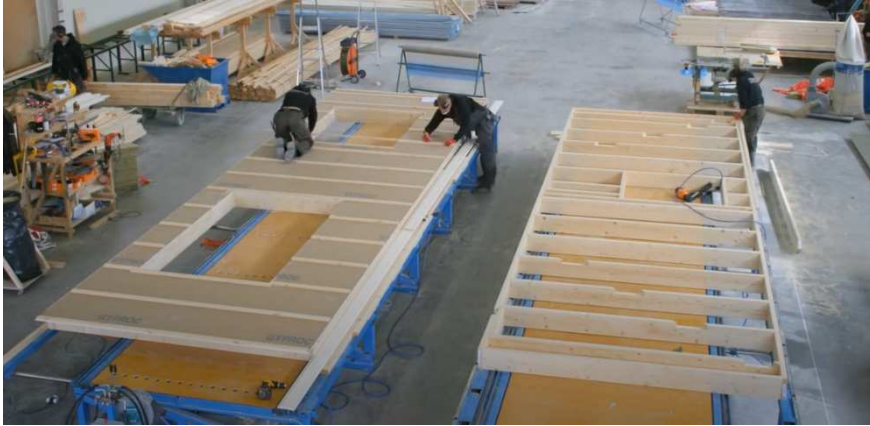
Figuur 11: Opbouw gesloten houtskeletpaneel (TimBecoWoodhouse,2021)
