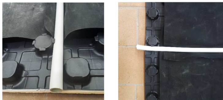
Figuur 37: testen van noppenplaat met folie
