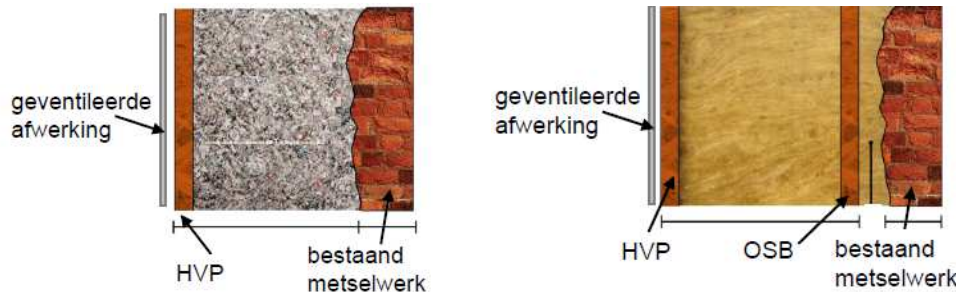
Figuur 14: Open houtskeletpaneel (links) en gesloten houtskeletpaneel (rechts) (PRO3, 2017)
