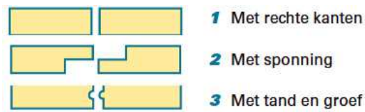
Figuur 28: Aansluitingsmogelijkheden isolatieplaten (Isolatiemateriaal, 2021)
