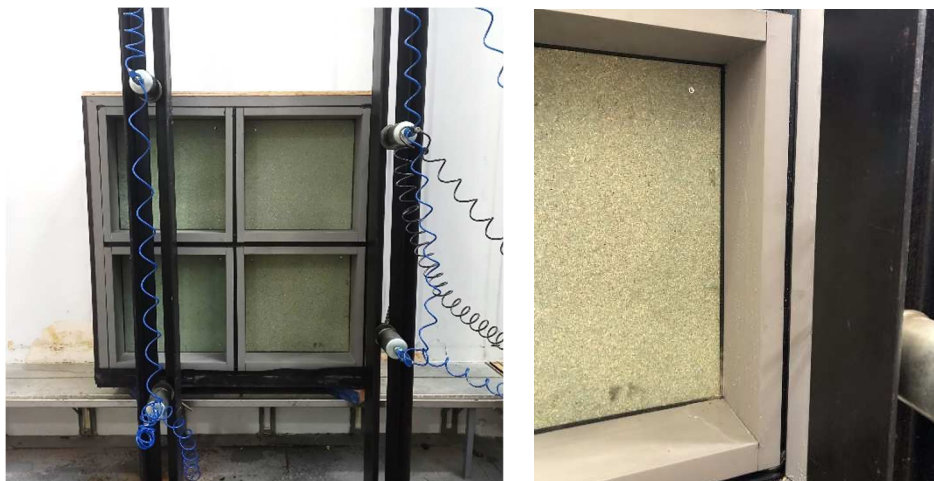
Figuur 41: Testopstelling (links) en water lekkage bij test (rechts)
