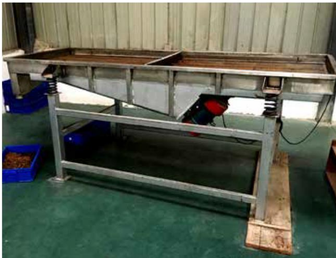
Figuur 8: Machinale zeef om larven te oogsten (uit: Dortmans et al., 2017).
