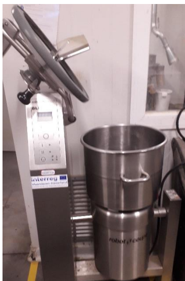
Figuur 12: Mixer gebruikt tijdens de experimenten (Blixer 30, Robot Coupe, Frankrijk).
