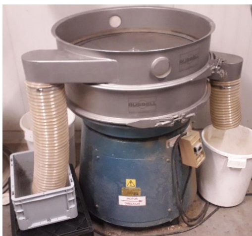
Figuur 14: Elektrische zeef (Finex separator, Russell, Verenigd-Koninkrijk): In de verticale buis links belanden de insecten, rechts belandt het restsubstraat.
