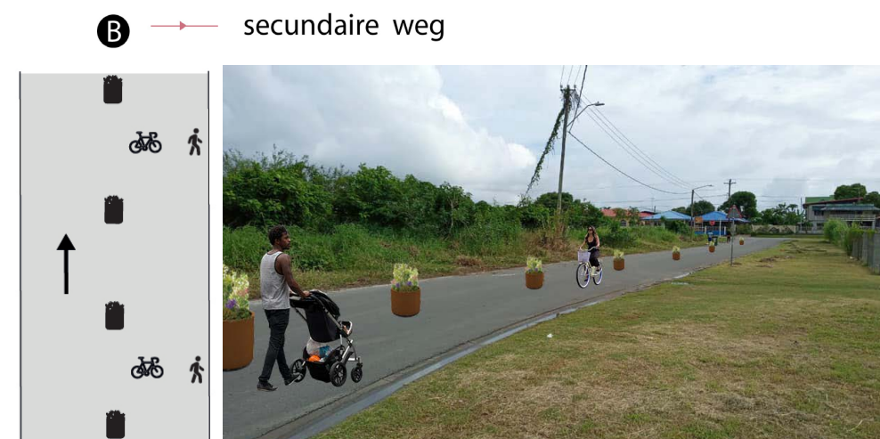
132. Secundaire eenrichtingsweg: principe wegversmalling
