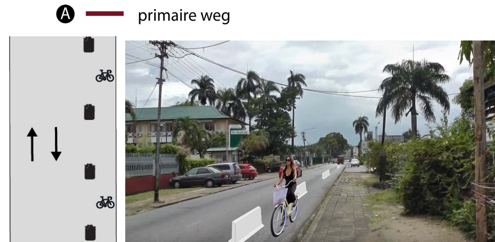
131. primaire tweerichtingsweg: principe wegversmalling
