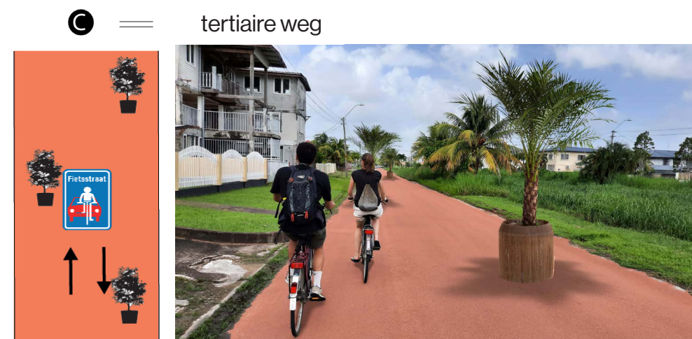
133. Tertiaire lokale weg: principe wegversmalling + asverschuiving
