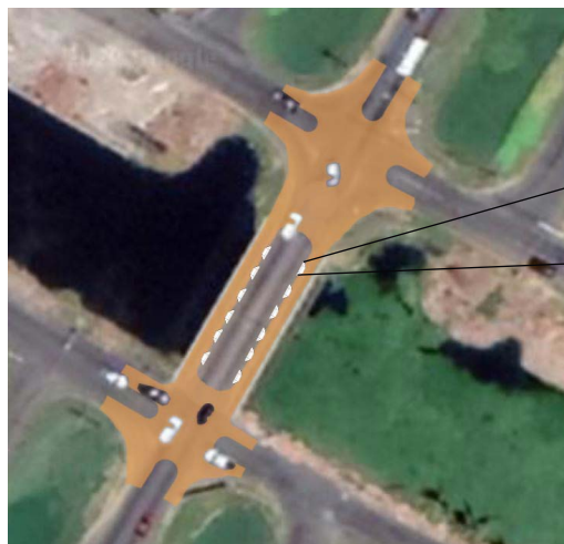
150. Stap 3 - niveauverschil voetpad en rijweg wordt verwijderd. Fietsvriendelijke stootbanden worden geplaatst ter afscheiding met de rijweg.
