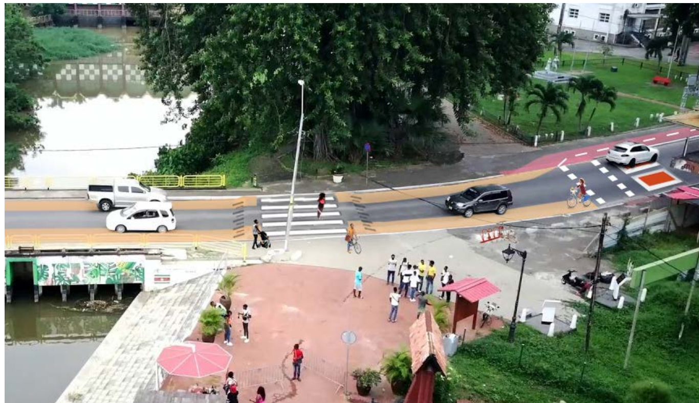
144. Beeld van stap 3: de urban tactics zijn opgepikt door de overheid. Er zijn een verhoogd zebrapad, suggestiestroken en verkeersremmende wegkussens toegevoegd om de omgeving veilig te maken en aandacht te vragen voor de zwakke weggebruiker
