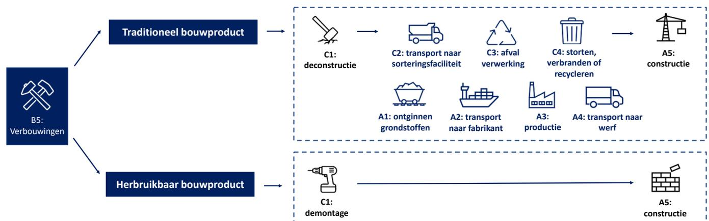
Fig. 1. De geïmplementeerde module B5 'verbouwingen' met de geëvalueerde impact modules voor circulaire en traditionele bouwelementen.
