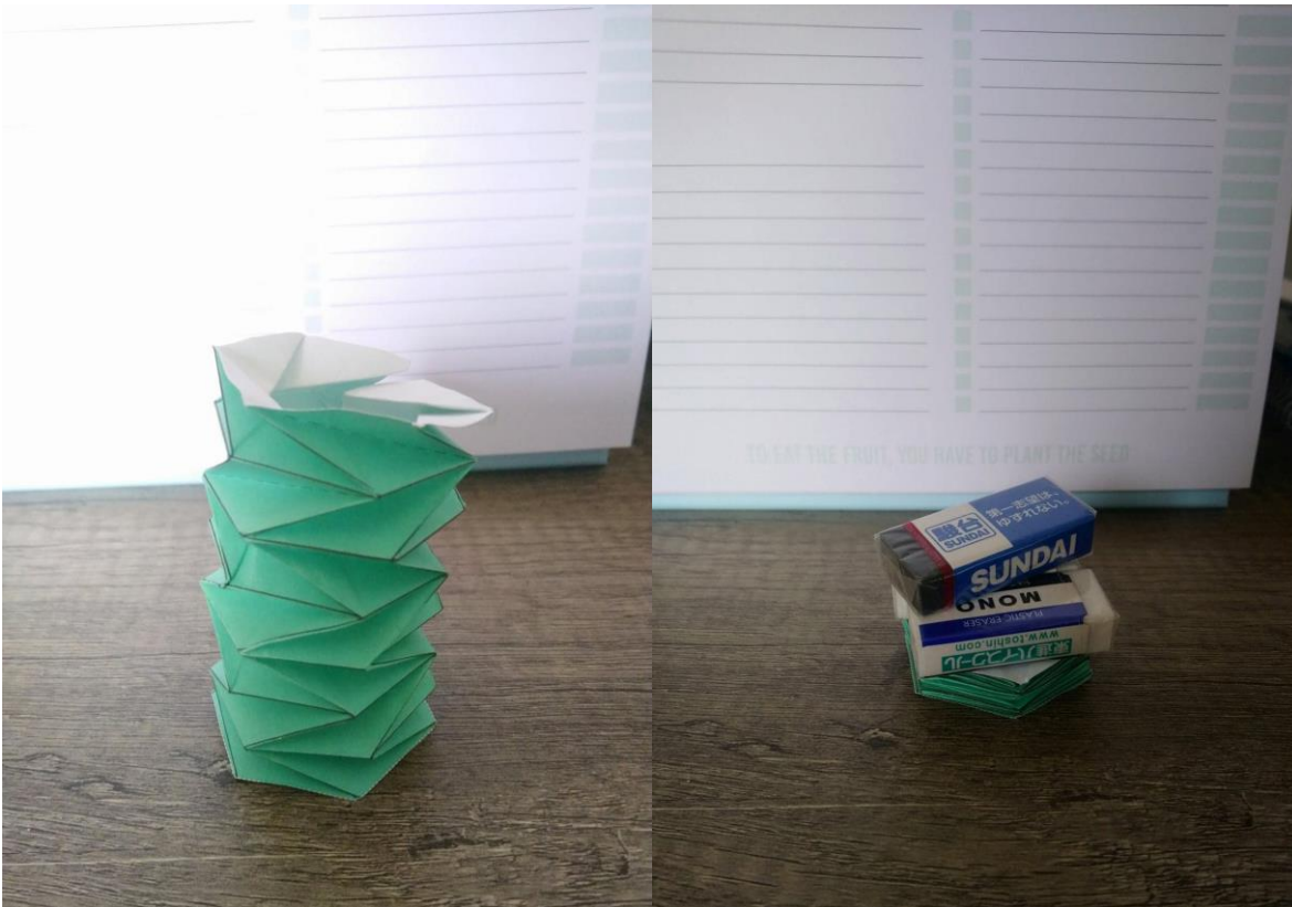
Figuur 138 Rechts, Kresling cilinder in samengedrukte toestand, dit door middel van enkele gommen. , Bron vouwtemplate: OriLab
