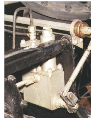
Figuur 7 Stoom regelklep met throttle link, http://www.walterwerke.co.uk/design/scvalve.htm
