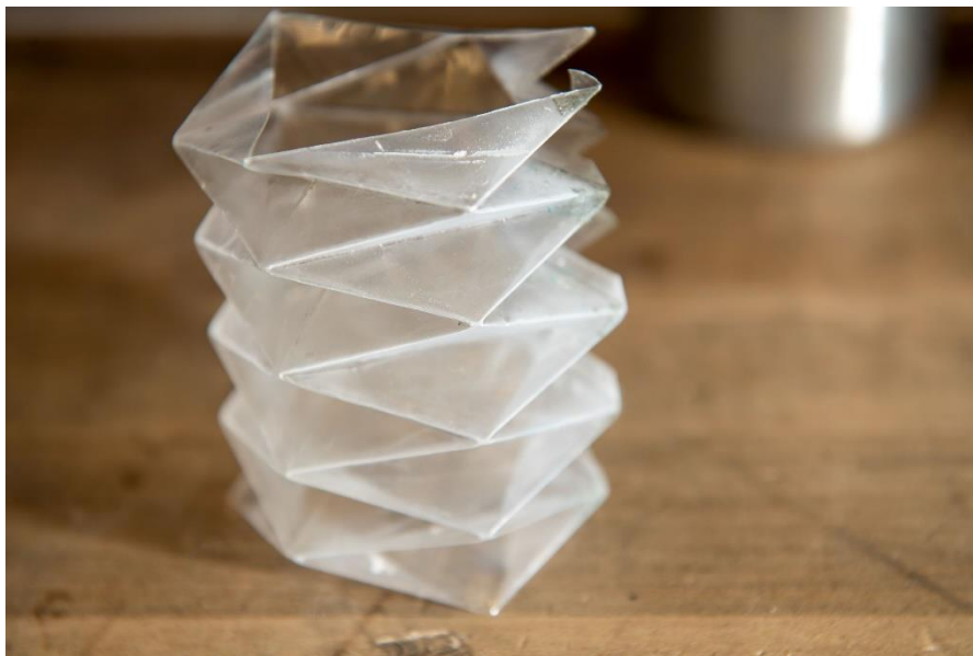
Figuur 121 Yoshimura origami bellows, gevacuümformed over een mal, Bron: WSU 2020
