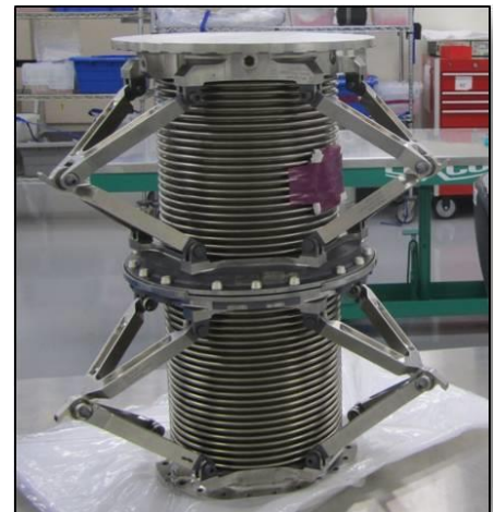
Figuur 14 Voorbeeld van flexibele "Bellows", NASA.gov
