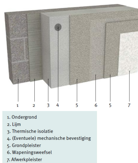
Figuur 91: Opbouw van een ETICS (WTCB, 2016, p.11)
