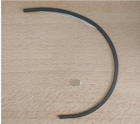
Figuur 35: 3D geprinte beugel van onyx in combinatie met glasvezel waarbij de vezel duidelijk tussen de printlagen uitkomt.
