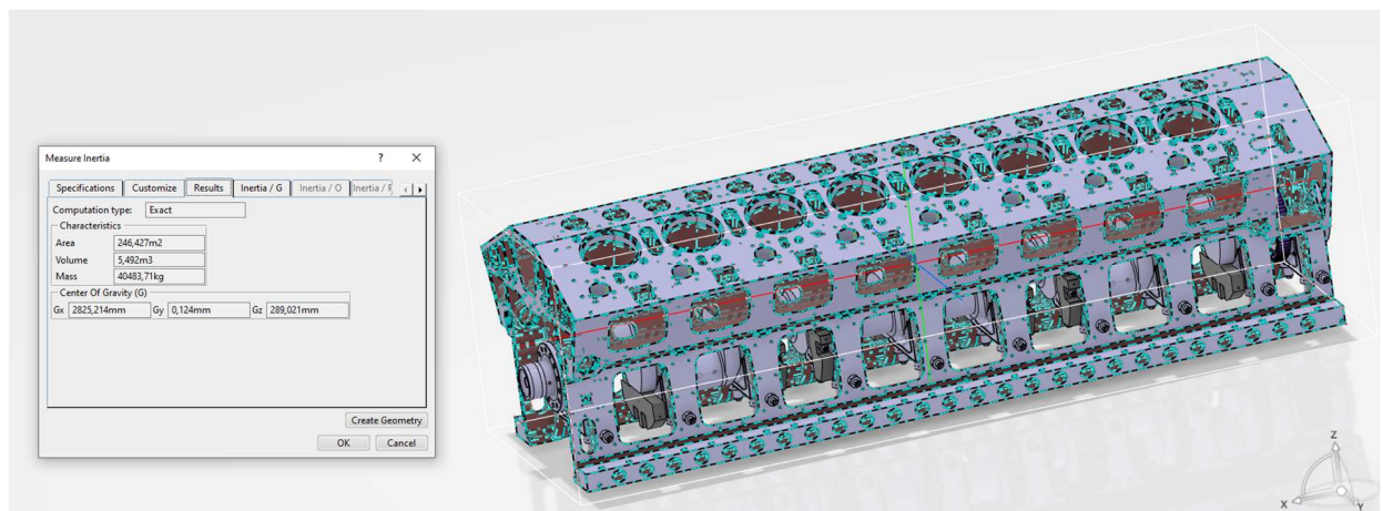
Figuur 101: Bepaling van de totale massa van het 16DV-motorblok
