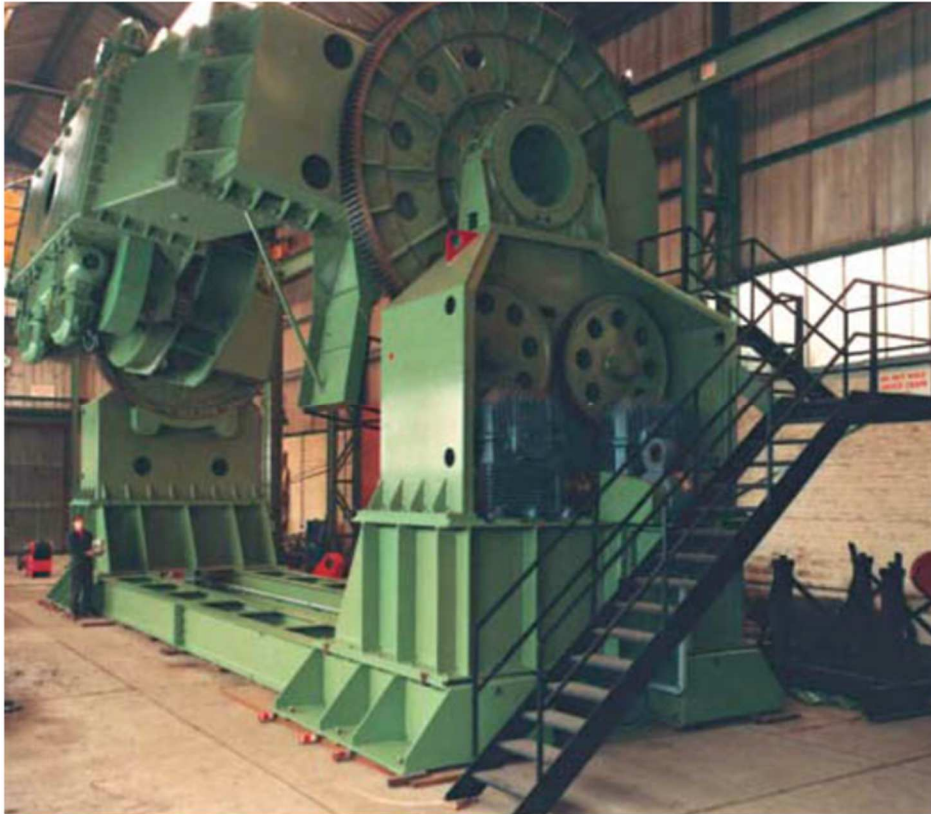
Figuur 4: Bode manipulator voor 220 000 kg met centrale brug en draaitafel [7]
