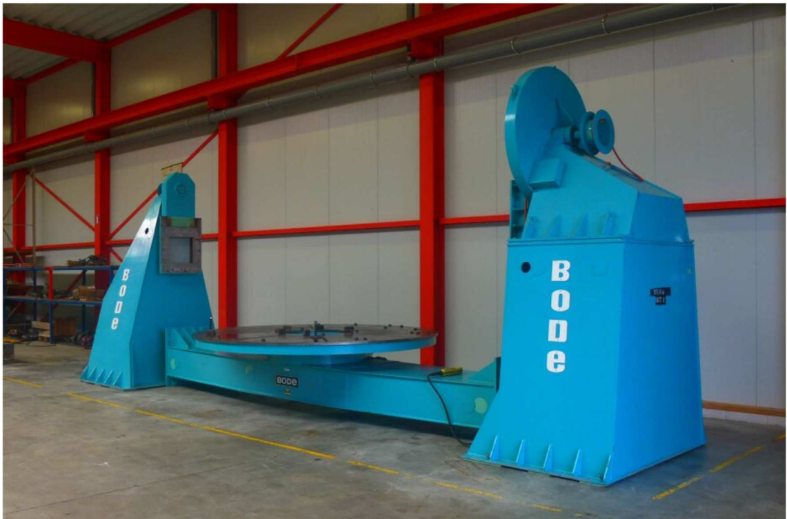
Figuur 3: Bode manipulator voor 5 000 kg met centrale brug en draaitafel [6]
