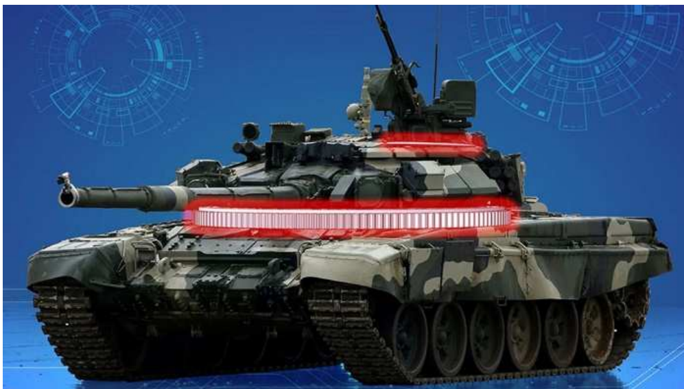
Figuur 22: Draaikranslager in de toren van een tank [21]
