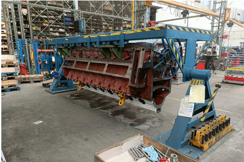
Figuur 2: Draaistoel met centrale brug van de opdrachtgever voor kleinere motoren
