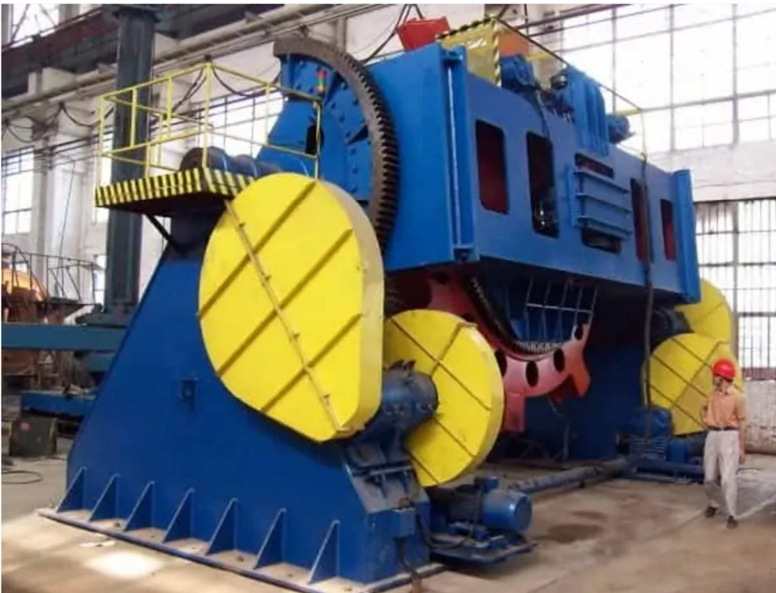
Figuur 5: Waldun manipulator voor 150 000 kg met centrale brug en draaitafel [8]
