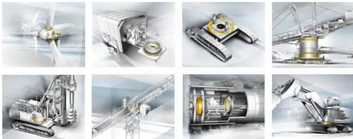
Figuur 23: Voorbeelden van het gebruik van draaikranslagers [22]
