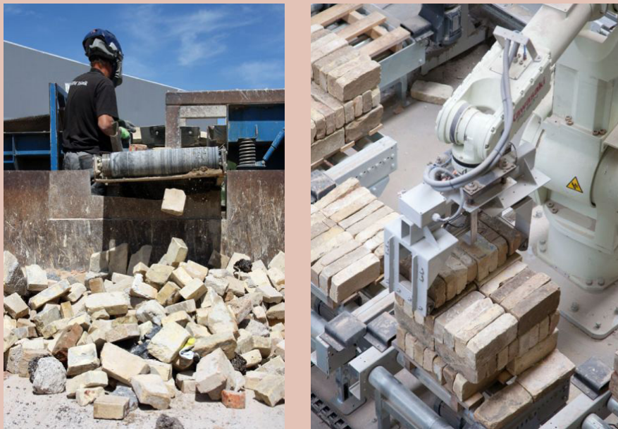
Figuur 36: Lopende band en palletiseer-machine in het bedrijf Gamle Mursten (Gamle Mursten, 2023a)
