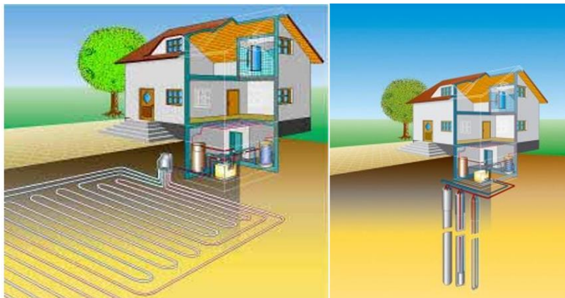
Figuur 67: Horizontaal systeem (links) en verticaal systeem (rechts) van boorgat thermische energieopslag (BTES)
