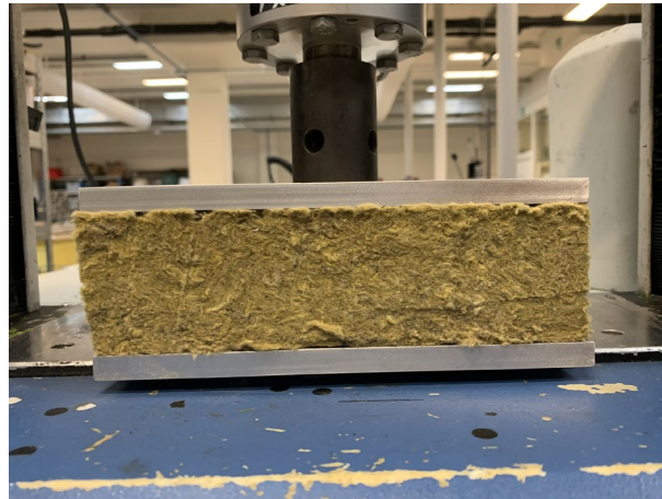
Afb. 76: Testmonster tussen de twee drukplaten geplaatst
