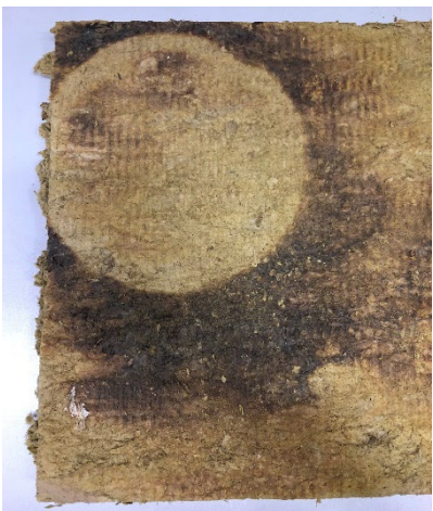
Afb. 36 (links): Schade aan de toplaag van de isolatie door het verwijderen van de dakdichting
