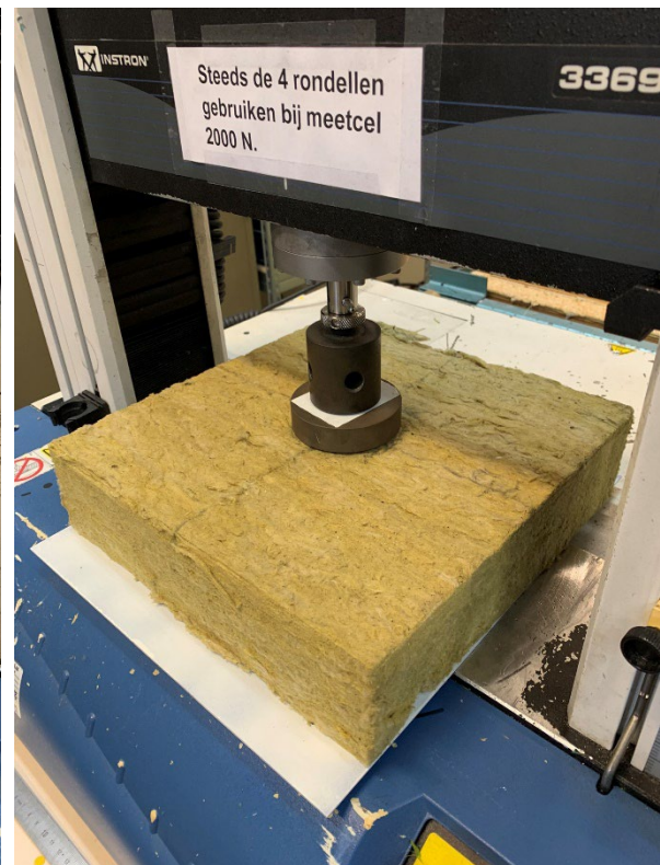
Afb. 81 (links): Druktestmachine met stalen cilinder vlak boven het testmonster
