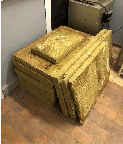
Afb. 33 (links): Bitumineuze dakdichting van de isolatie getrokken
