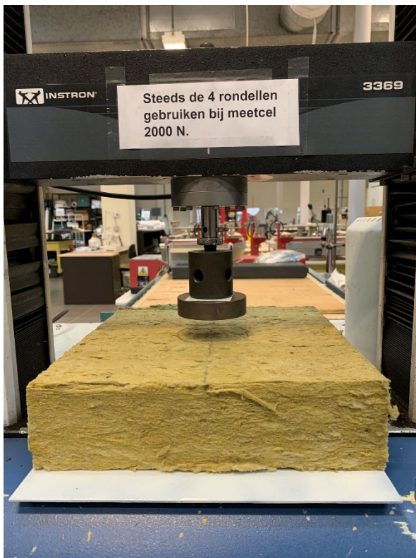
Afb. 81 (links): Druktestmachine met stalen cilinder vlak boven het testmonster
