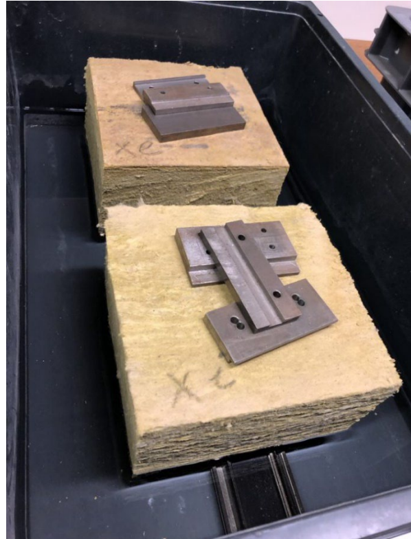
Afb. 59 (links): Testmonster uitgesneden op de juiste afmetingen Afb. 60 (rechts): Testmonsters geplaatst in het waterreservoir
