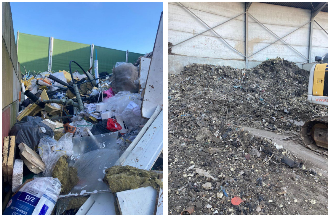
Afb. 1 & 2: Foto's van Devagro, voor (links) en na (rechts) het versnipperen van het bouwafval (inclusief isolatie)
