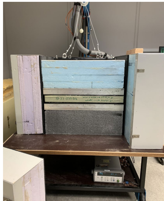
Fig. 4 (links): Configuratie van lambda-waarde metingen met een warmtestroommeter overgenomen uit NBN EN 12667 Afb. 84 (rechts): Proefopstelling van de warmtestroommeter in het laboratorium van Buildwise
