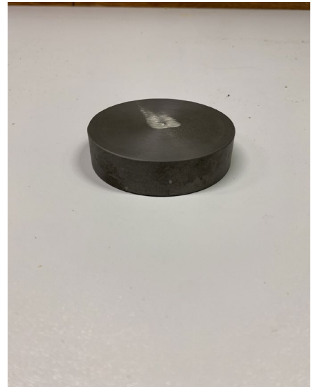
Afb. 79 (links): Testmonster waarop de cirkel voor de puntlast werd uitgetekend
