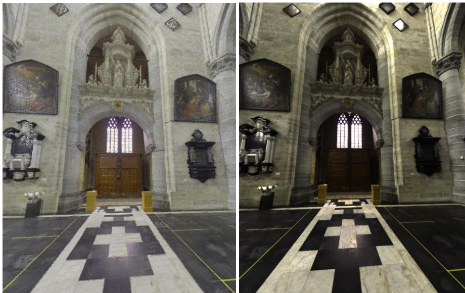
Figuur 9: Puntenwolk kleur scanner (links) en panoramisch beeld in HDR (rechts)
