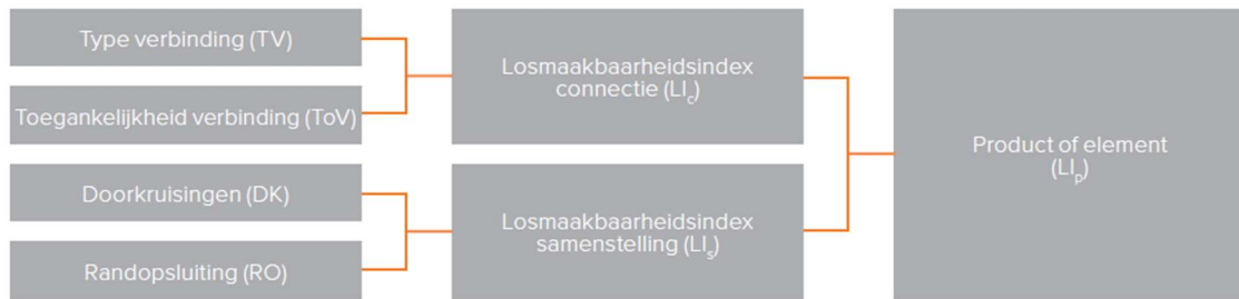
Figuur 31 : Stappenplan beoordeling Losmaakbaarheidsindex (circular buildings Losmaakbaarheidsindex 2.0)
