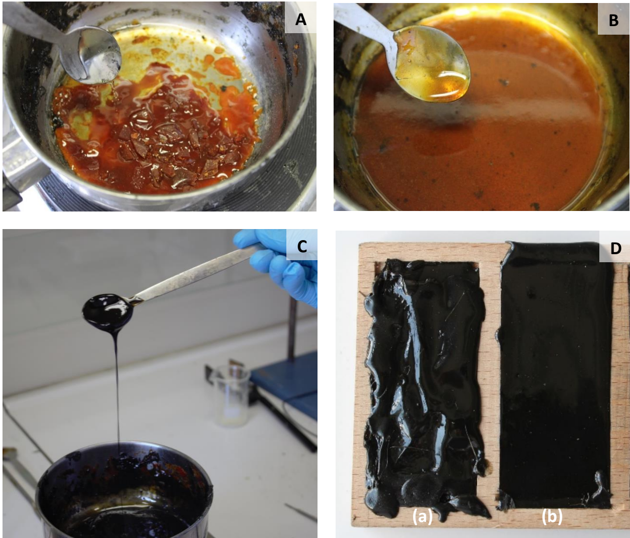
Fig. 48. Bereiding van lak met Venetiaans terpentijn. (A) Smelten van de schellak bij een temperatuur van 150°C. (B) Toevoeging van Venetiaans terpentijn aan de gesmolten lak. (C) Lak na toevoeging van lampenzwart. (D) resultaat na gieten van de lak in de uitsparingen: (a) (1:1:3) Venetiaans terpentijn – dennenhars ( Abies alba ) – schellak. (b) (1:1) Venetiaans terpentijn – schellak.
