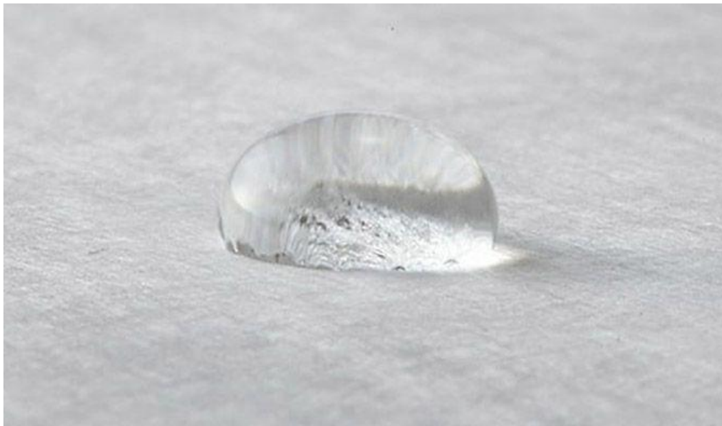
Afbeelding 7.12: DuPont, Tyvek® (detail structuur materiaal), 2023.
