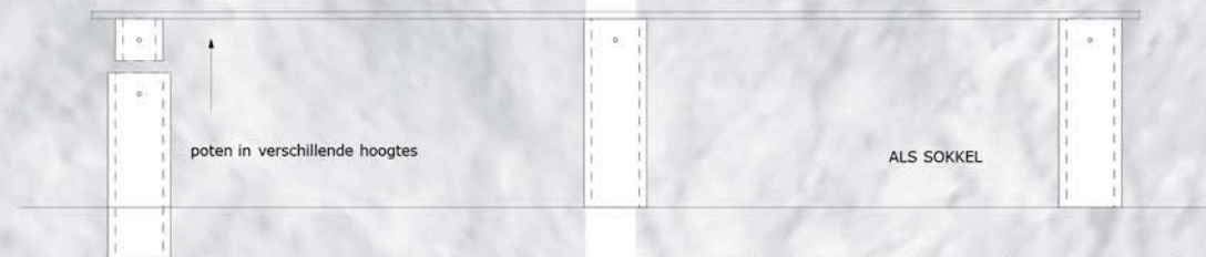
Afb. 130: tekening tentoonstellingselement als sokkel/tafel met poten in verschillende hoogtes, schaal 1/20.
