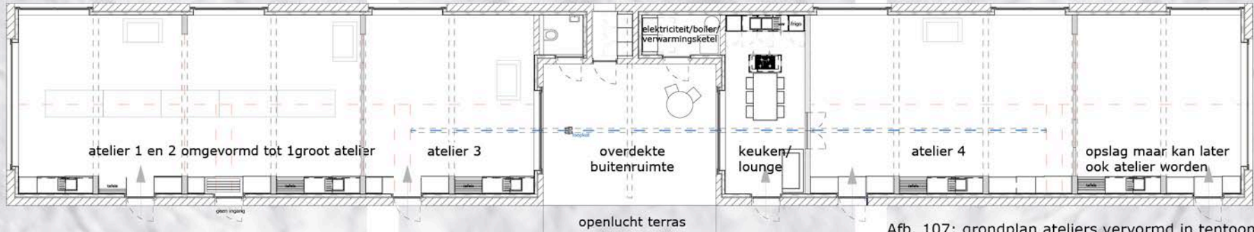
Afb. 107: grondplan ateliers vervormd in tentoonstellingsruimtes, schaal 1/200.
