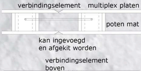
Afb. 135: tekening tentoonstellingselement als paneel, aan elkaar geschakeld.
