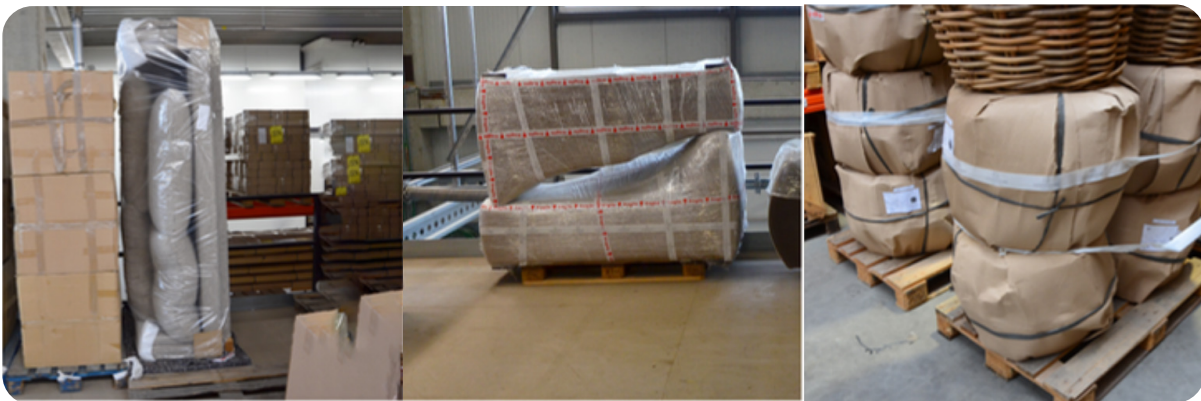
Figuur 1.31-1.33: opslag en stapelen hoe het niet moet
