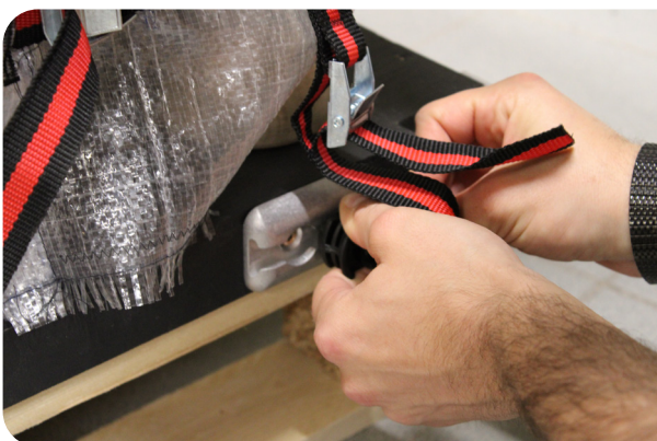
Figuur 4.37: spanoog vastklikken in vliegtuigrail
