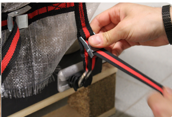
Figuur 4.38: band aanspannen verbinding doek aan plaat
