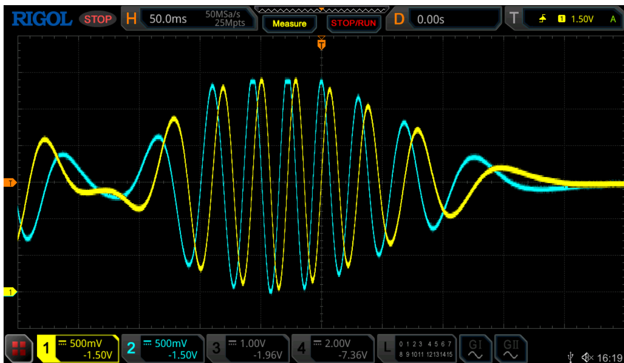
Figuur 5 Gemeten IQ-sigitaal in de praktijk
