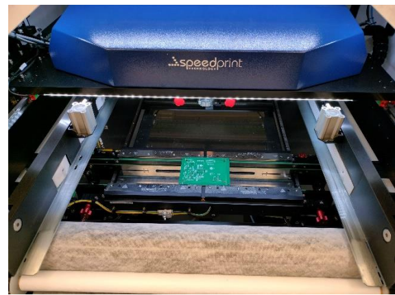
Figuur 62 Stencil machine met PCB
