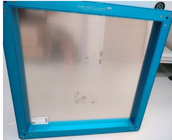
Figuur 58 Stencil Radar board opgespannen kader
