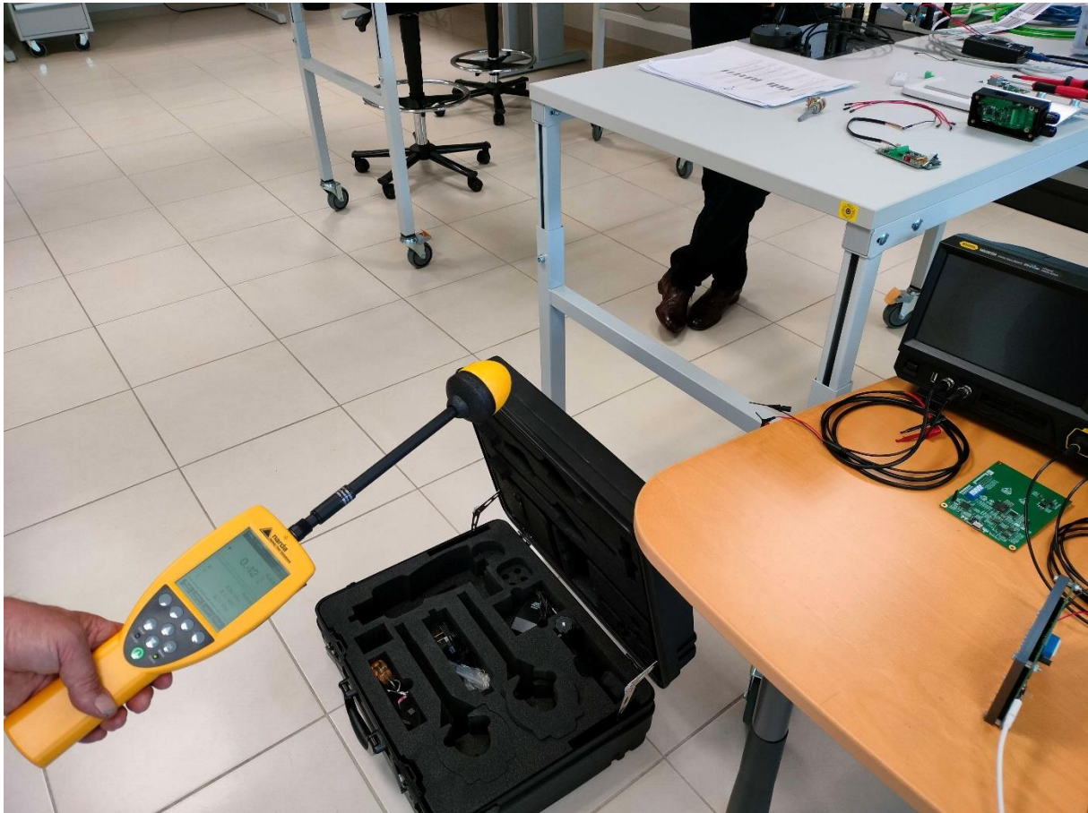
Figuur 72 Near field meting IVQ-3005 op 14dBm, resultaat op ~60cm = 0.4V/m
