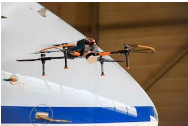
Figuur 43: Drone die ingezet worden om coating van het vliegtuig te analyseren
