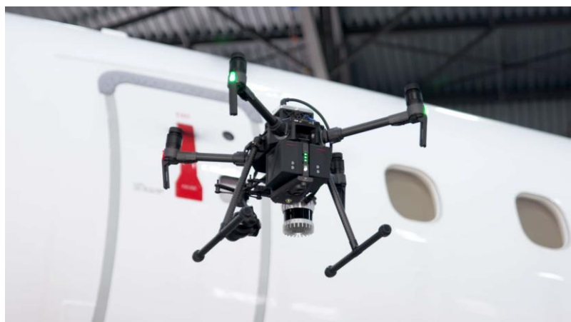
Figuur 25: Test van een drone die gebruik wordt bij vliegtuigonderhoud
