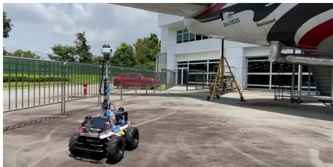
Figuur 42: Robot die beelden maakt van de zijkant van het vliegtuig (bereik van 2 meter)
