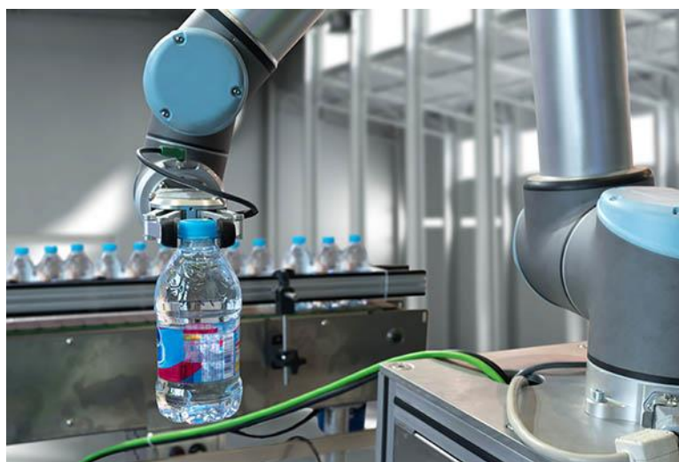
Figuur 20: Voorbeeld van een pick-and-place robot die een flesje vastneemt
