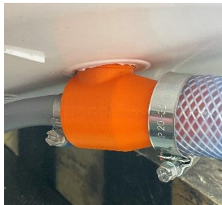
Figuur 124: Venturi-pomp aangesloten op installatie
