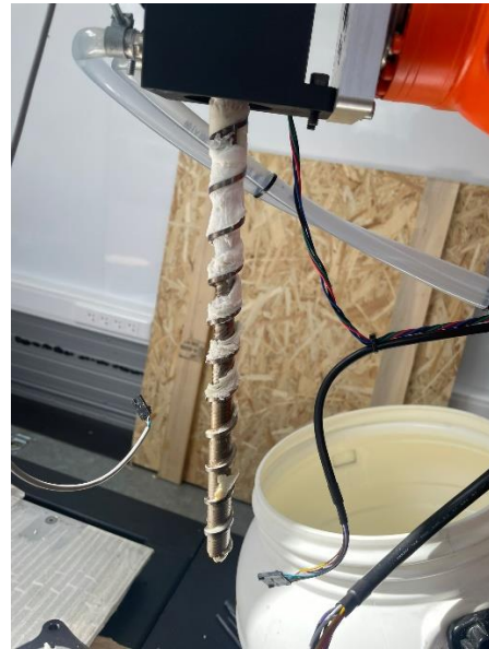
Figuur 68: Ophoping op schroef
