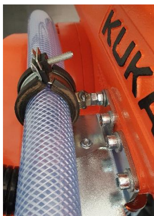
Figuur 117: Buisklem op joint A3
