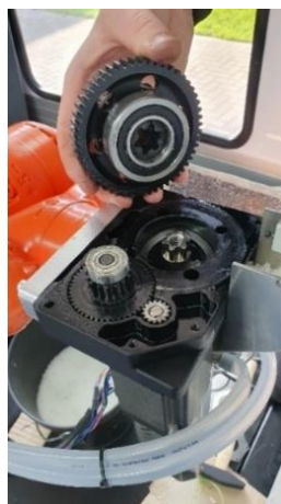
Figuur 33: Demonteerde reductiekas
