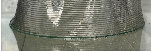
Figuur 91: Goed hechting PETG op verwarmt glas
