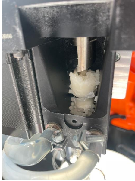
Figuur 67: Materiaal ophoping extruder
