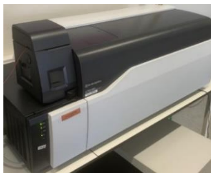
Figuur 13: Gebruikte LCMS-8050 Triple Quadrupole Mass Spectrometer (eigendom van BioNotus)
