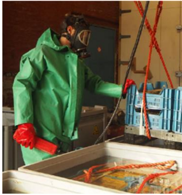
Afbeelding 41: Tegels worden in het zuurbad geplaatst om de mortelresten te verwijderen (De Wilde Vincent, 2023)
