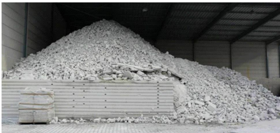
Afbeelding 4: cellenbetonafval dat wordt ingezet in de nieuwe productie (Xella, 2024)
