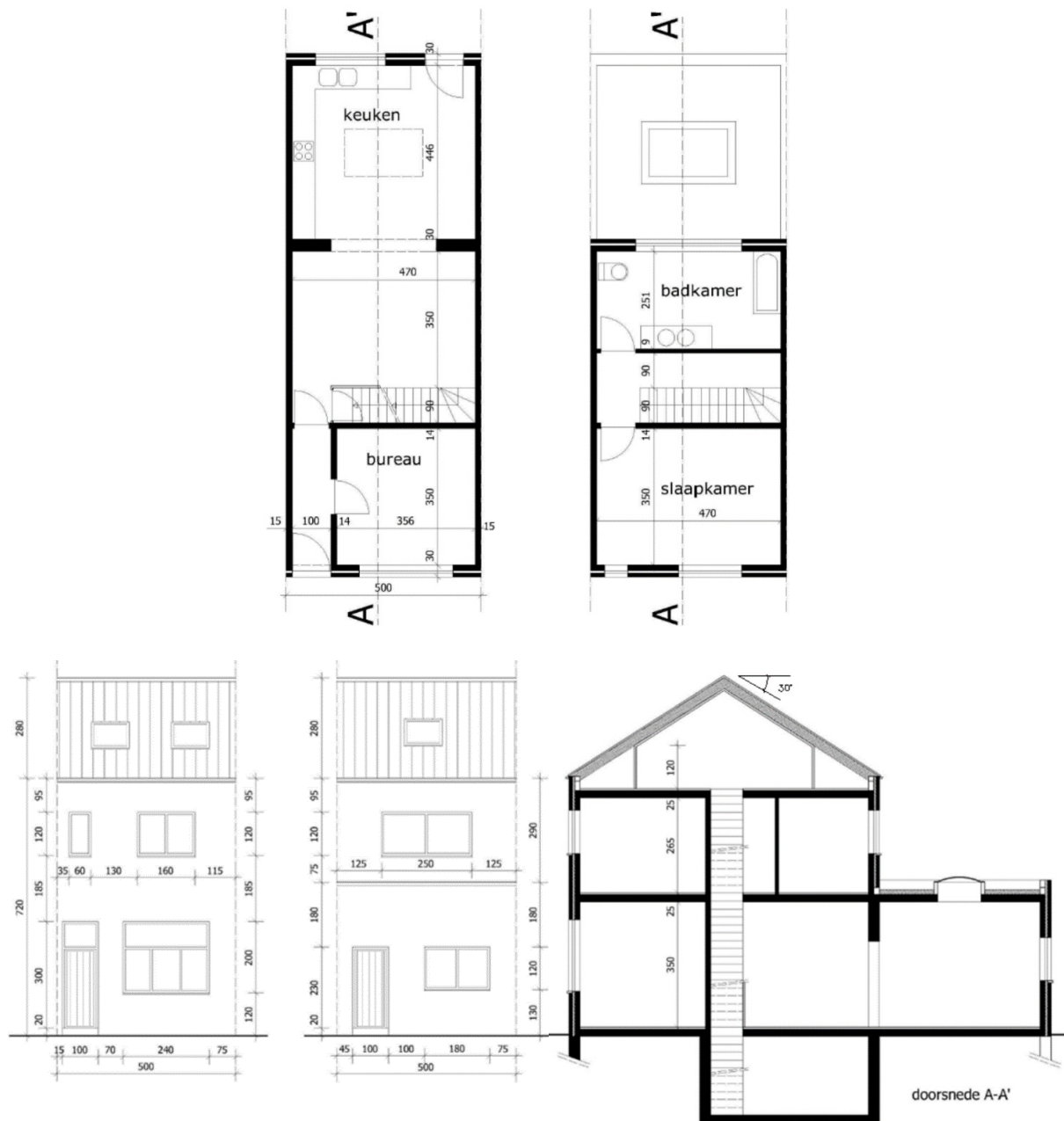
Figuur 9: Grondplannen - gelijkvloers en eerste verdieping (bovenaan), gevelaanzichten - voor- en achtergevel (links) en snede (rechts) van de rijwoning (Van Der Veken et al., 2015)
