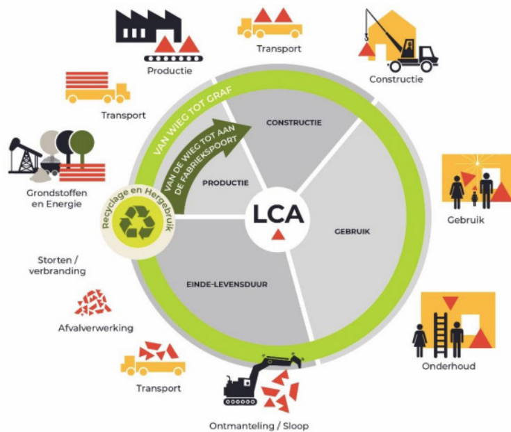
Figuur 3: De verschillende fasen bij een levenscyclusanalyse (LCA) (Wastiels et al., 2021)
