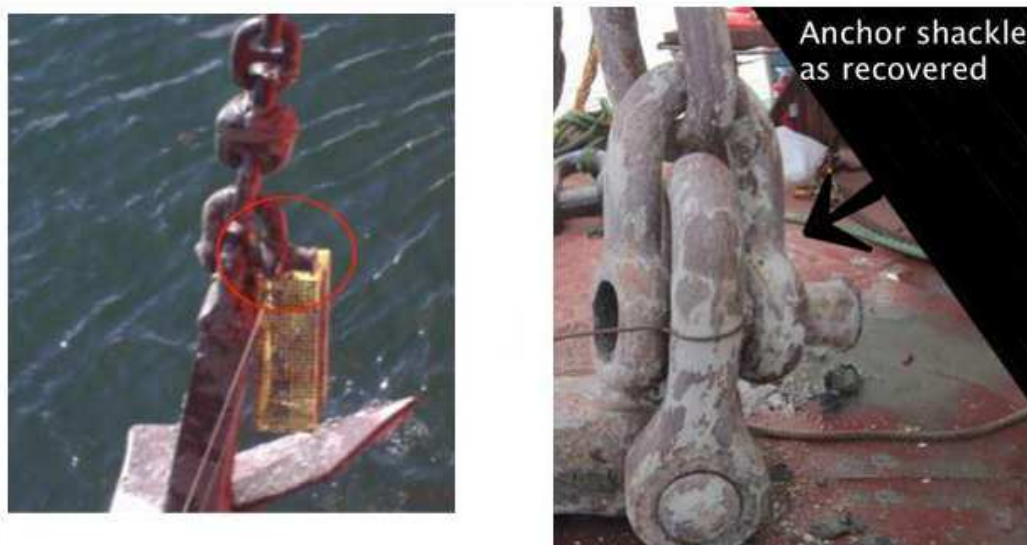
Figuur 11: Losgeraakte borgpen D-sluiting
