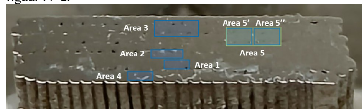
Figuur IV-2: Dwarsdoorsnede van proefstuk 3A met aangegeven locaties van de onderzochte gebieden.
