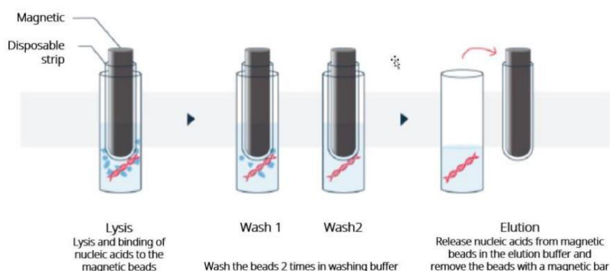
Figuur 31: Overzicht van de stappen ondergaan door de IndiMag 48s bij de zuivering van nucleïnezuren. (Indical Bioscience, 2021)
