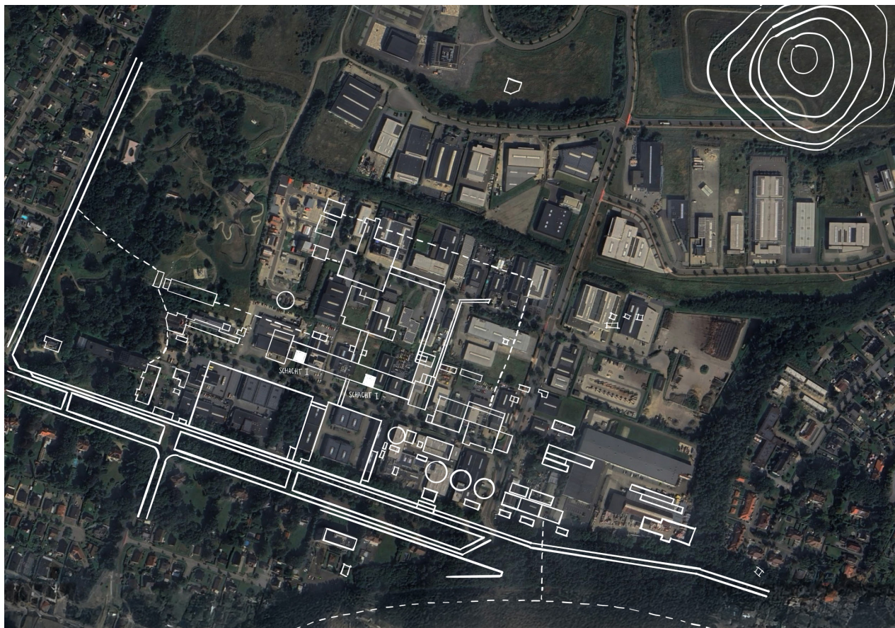
Fig. 60: Illy Klerckx (2025), Tekening mijngebouwen Zwartberg op huidige situatie. Fig. 61: Illy Klerckx (2025), Zoom van figuur 60. De witte ingekleurde vierkanten wijzen op de voormalige locatie van de schachtbokken. Hier bevinden zich vandaag de dag met-betonvolgestorte putten. Deze zullen de drager zijn van statische elementen in het ontwerp.
