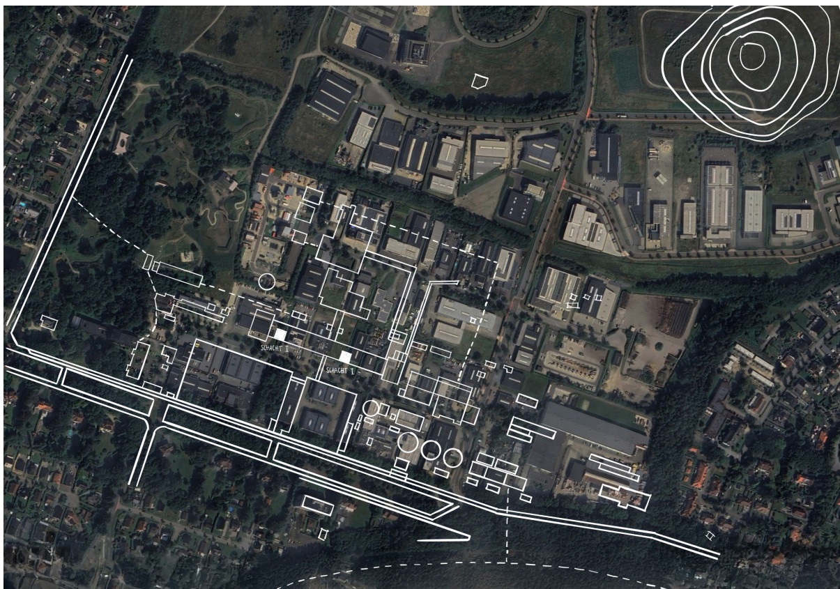
Fig. 13: Klerckx Illy (2025), Tekening mijngebouwen Zwartberg op huidige situatie. De witte ingekleurde vierkanten wijzen op de voormalige locatie van de schachtbokken. Hier bevinden zich vandaag de dag met-beton-volgestorte putten. Deze zullen de drager zijn van statische elementen in het ontwerp.
