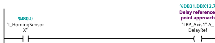
Figuur 6.12: Ladderdiagram waarin de naderingssensor de referentieprocedure van de X-as activeert
