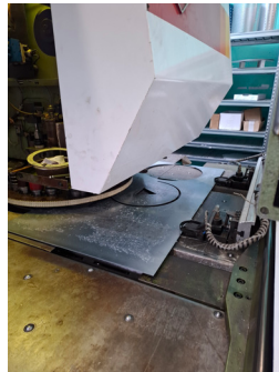
Stalen plaat onderstuk in CNC-tekenprogramma en onder de ponsmachine
