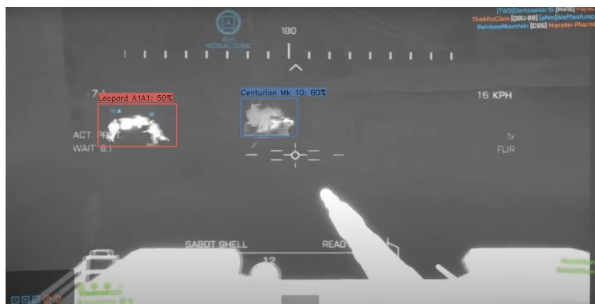
Figuur 5.5: Een brandende tank wordt succesvol gedetecteerd (rechts) terwijl een quad met twee spelers errond foutief gedetecteerd is (links) [8]
