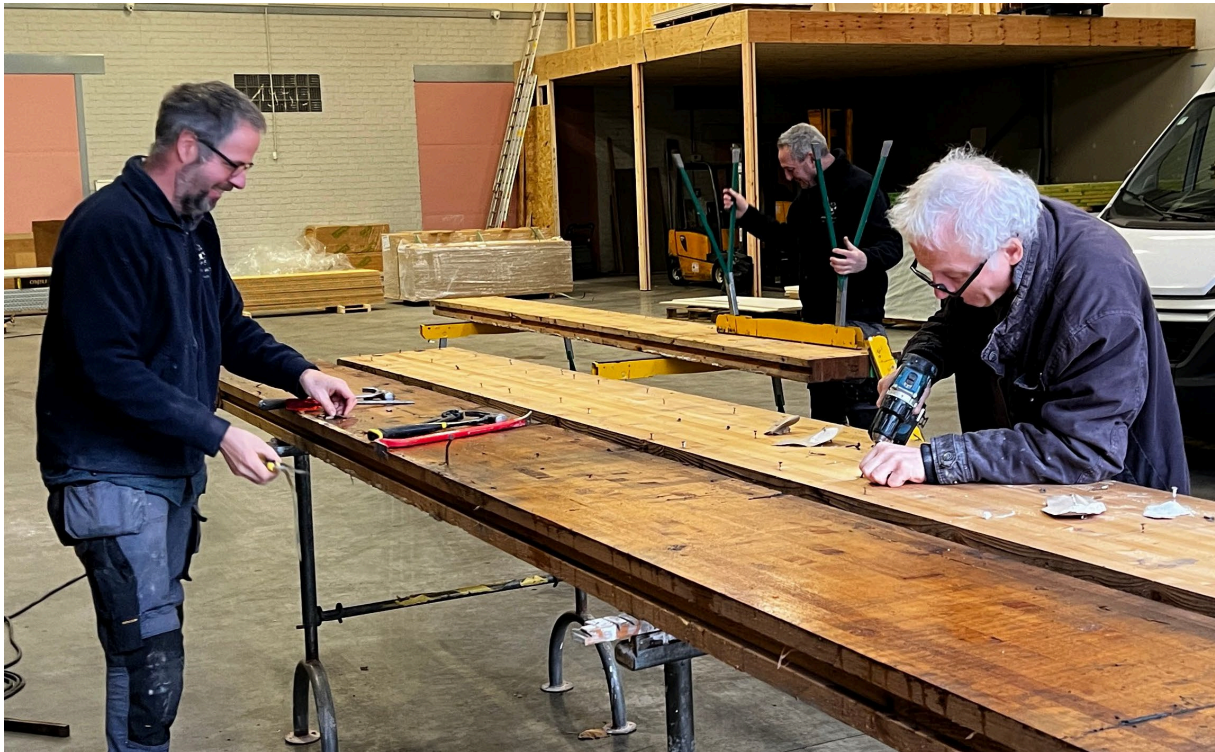
Figuur 91: Verwijderen van metalen elementen uit een glulam balk met manuele tools en schroefboormachine (casus 2.2) (W. Thys, 2024)
