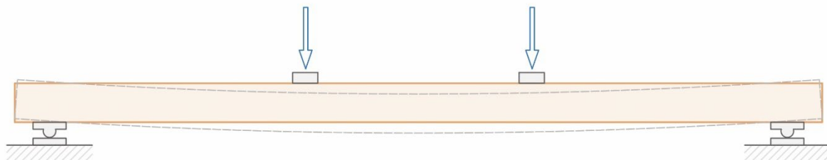
Figuur 102: Schematische weergave van een vierpuntsbuigproef
