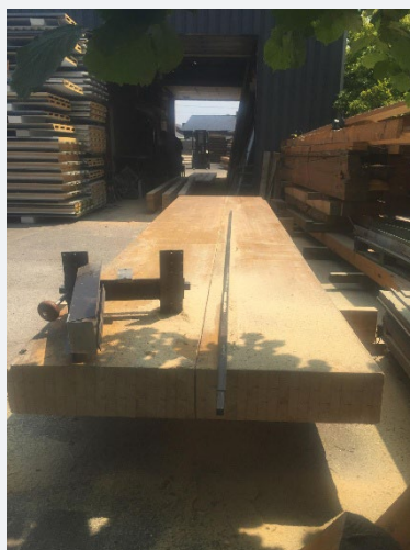
Figuur 75: Verzaging van een balk bij Kameleon (G. Polfliet, 2024)
