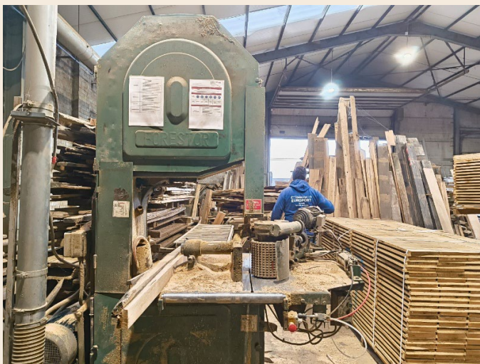
Figuur 5: Lintzaagmachine waarmee balken tot planken worden verzaagd. Rechts ligt een stapel afgewerkte planken
