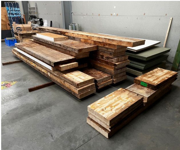
Figuur 38: De balken na het verwijderen van metalen onderdelen en opschonen ( W. Thys, 2024 )
