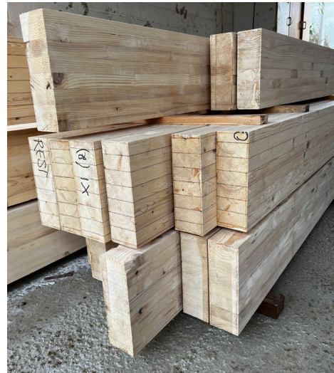
Figuur 39: De balken na het schaven ( W. Thys, 2024 )
