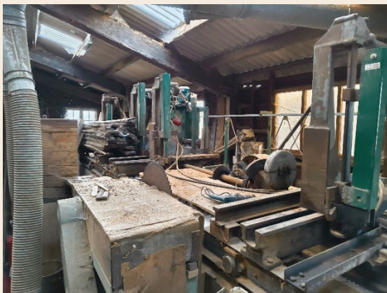
Figuur 16: Antieke verzagingsmachine voor het verwerken van balken
