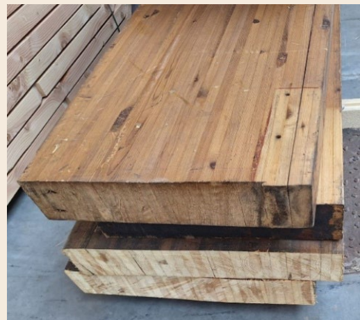
Figuur 92: Glulamoppervlak na het schoonspuiten (O. Kurtulus, 2025)
