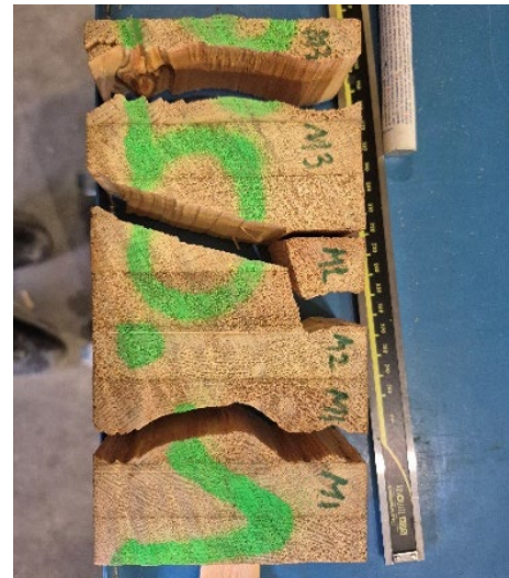
Figuur 101: Glulamstaal na delaminatietest (casus 2.3) (Buildwise, 2025)
