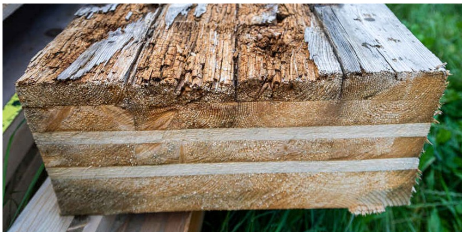
Figuur 6 - Aangetast CLT paneel na aanhoudende vochtblootstelling (Birk S., 2021).
