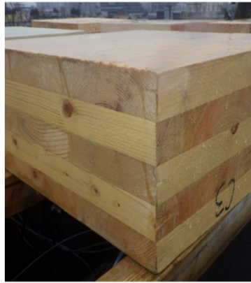
Hydrofobe coating op paneel
