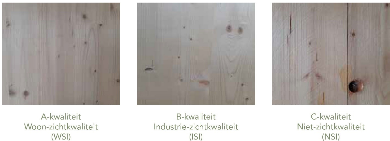
Figuur 51 - Oppervlaktekwaliteit CLT (Laminated Timber Solutions, 2019)
