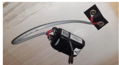
Figuur 121 - Vochtsensor met losgekoppelde elektroden, gemonteerd aan de onderzijde van een CLT-tussenvloer. De elektroden bevinden zich op 80mm (Tector, 2025)
