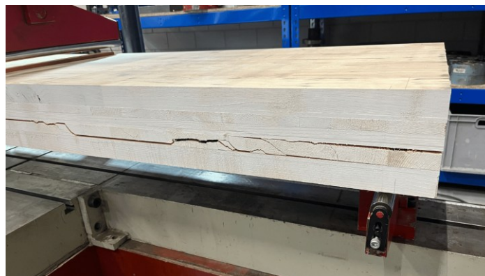
Figuur 7 - Breukbeeld van C-CLT dat significant anders is dan normaal CLT: Breuk in de binnenste lagen (afschuiving) in plaats van in de buitenste laag (trek) (TNO, 2024)
