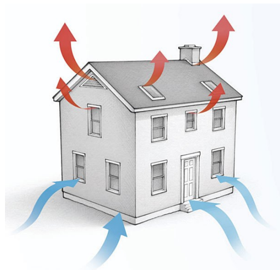
Figuur 38 - Illustratie van het schoorsteeneffect (Fine Homebuilding, 2022).
