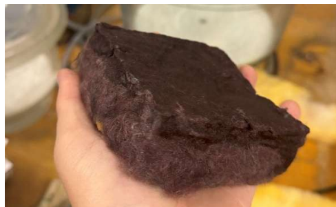
Figuur 43: Acrylstaal na absorptieproef: Verzadigde onderkant - droge bovenkant
