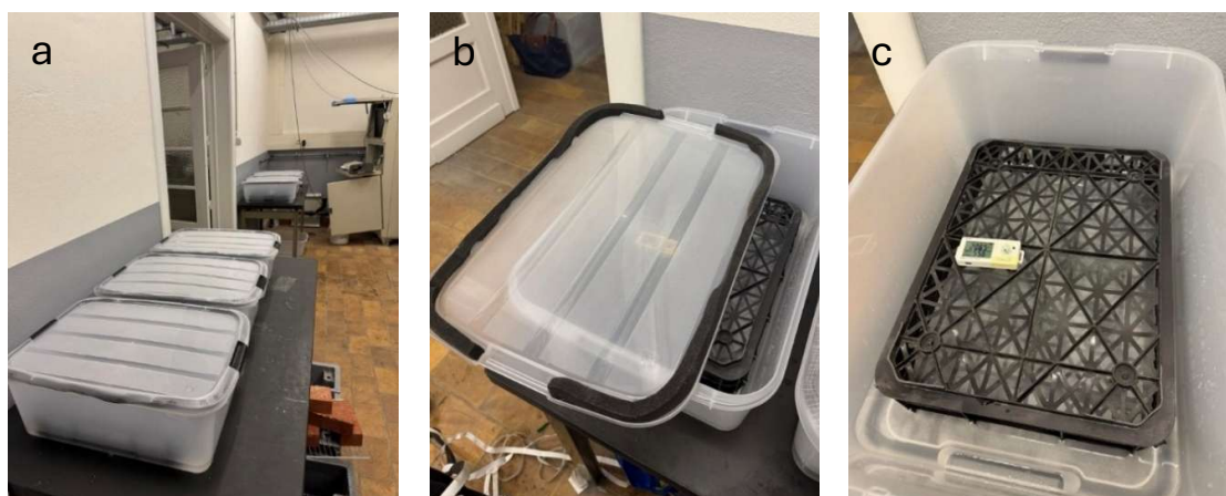
Figuur 44: Opstelling sorptieproef: (a) boxen; (b) zwelband; (c) rooster
