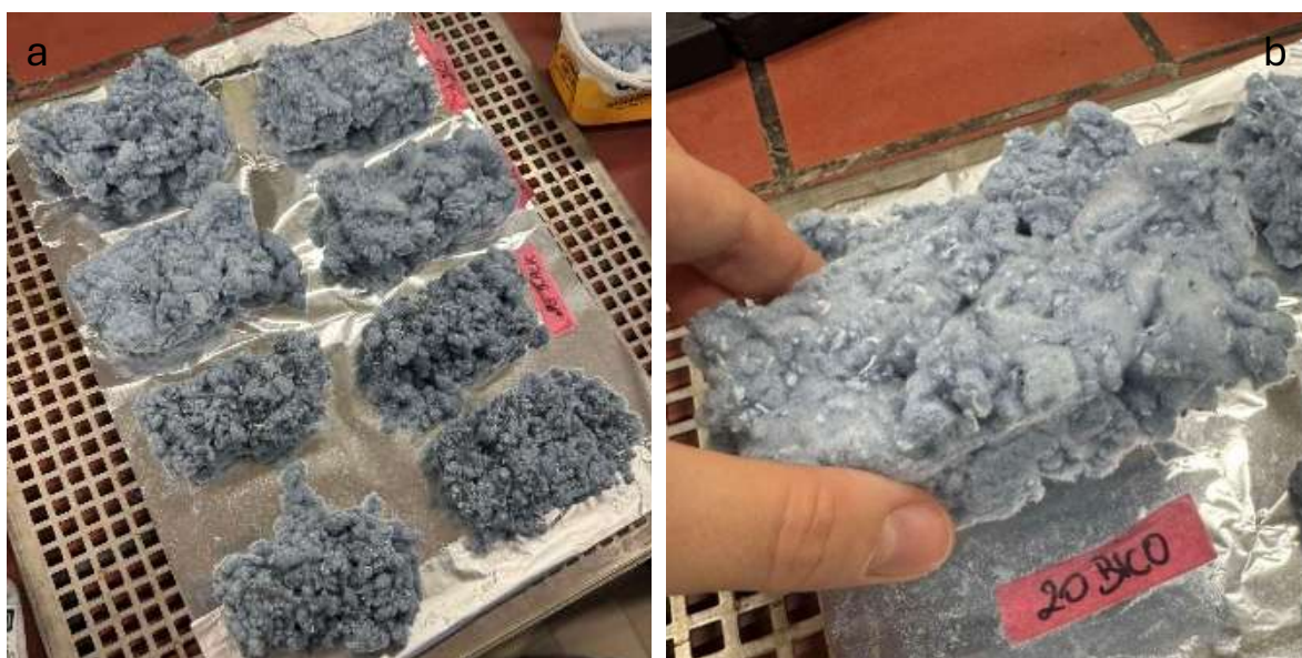
Figuur 53: Resultaten proefproductie: (a) verschillende stalen met variatie in verhouding en bindmiddel; (b) staal 3
