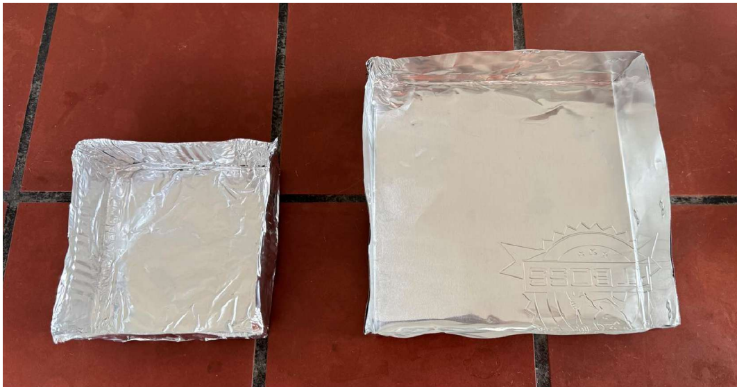
Figuur 28: Gebruikte aluminium mallen - 10x10 cm (links) en 15x15 cm (rechts)
