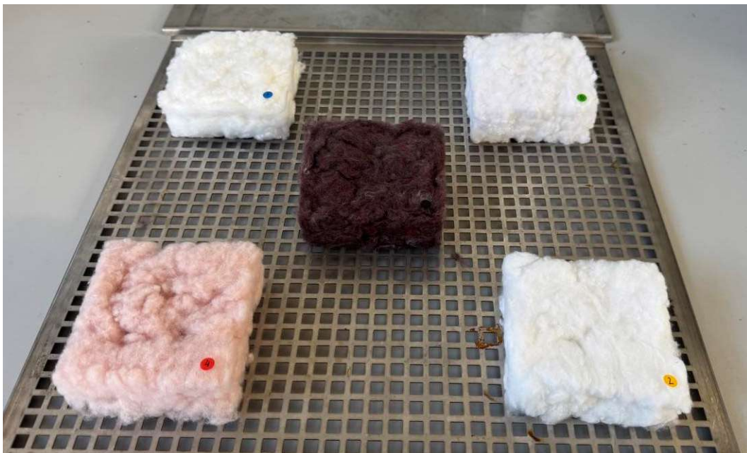
Figuur 19: Geproduceerde stalen (10x10x4 cm)
