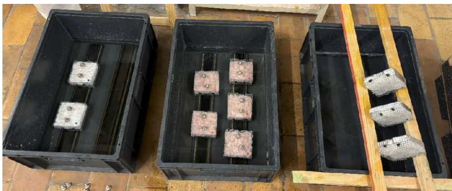
Figuur 35: Opstelling waterabsorptieproef
