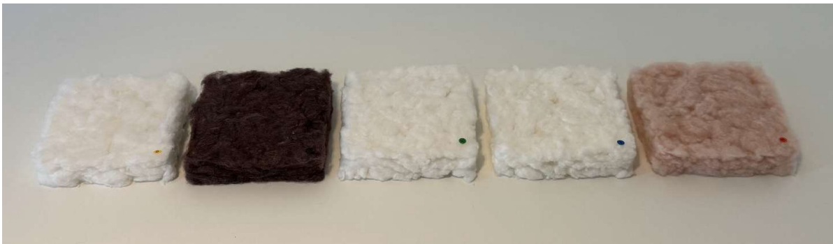
Figuur 29: Isolatiestalen - gerangschikt volgens vormvastheid (oplopend van links naar rechts: polyester – acryl – katoen/polyester – katoen – wol)
