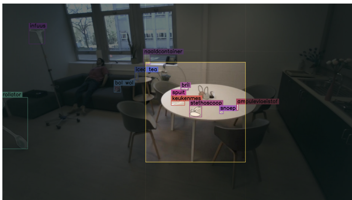
Figuur 8.2: Voorbeeld van een frame uit de labeling tool. Hier wordt een voorbeeld van een crop getoond die gebruikt kan worden voor het trainen van een objectdetectiemodel. Het is dus belangrijk dat alle objecten die binnen deze crop kunnen vallen, worden gelabeld, zelfs als ze niet volledig zichtbaar zijn. Merk op dat dit niet de enige mogelijke crop is binnen deze afbeelding, men kan ook andere regio's selecteren met andere objecten.
