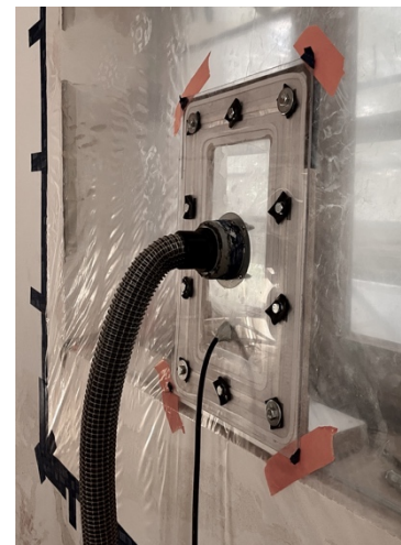
Figuur 4: Aansluiting op mal (in situ)
