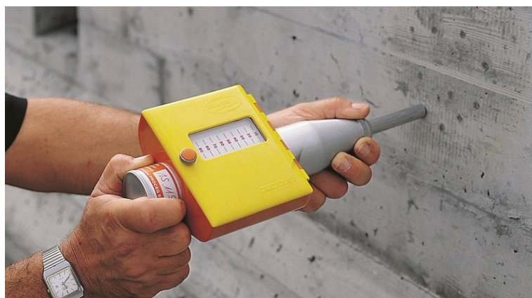
Figuur 91: Proceq Schmidthamer type LR. Overgenomen van Meetinstrumenten Verhuur.
