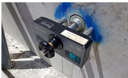
Figuur 101: Proefopstelling aanhechtingsproef. Overgenomen van Field tests (non destructive) , door STATS Australia.
