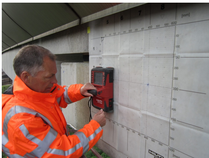
Figuur 93: Niet-destructief onderzoek naar wapeningsconfiguratie. Overgenomen van Wapeningsconfiguratie , door Nebest.
