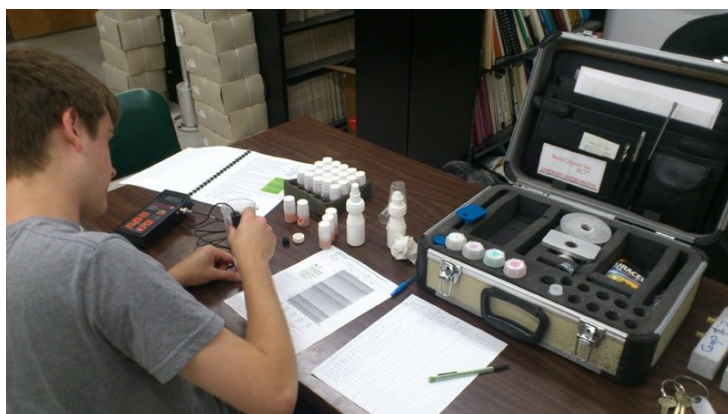
Figuur 112: Uitvoeren van een chlorideproef. Overgenomen van Martin Memorial Center, North Parking Garage , door Innovative Engineering.
