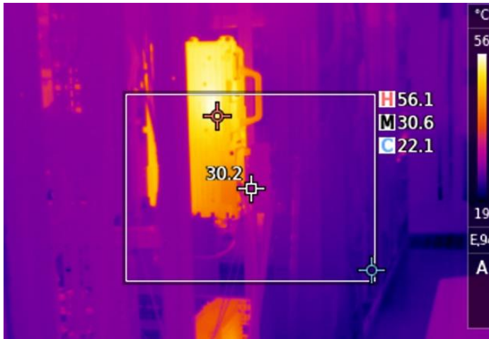
Figuur 38: Warmtebeeldfoto locatie H (temperatuurschaal 19°C tot 56°C)
