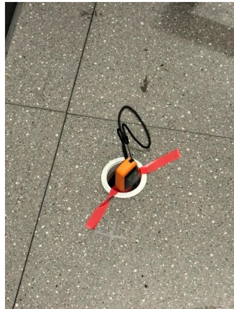
Figuur 31: Uitblaastemperatuur meting klimaatkasten
