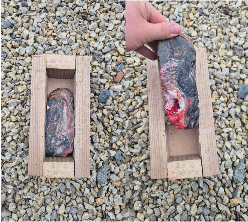
Figuur 14: houten blokvorm mal met gepreste blok plastic.
