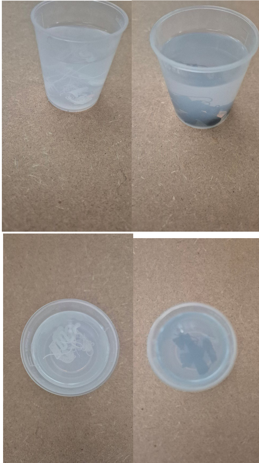
Figuur 21: isopropanol test na 12u in de vloeistof.
