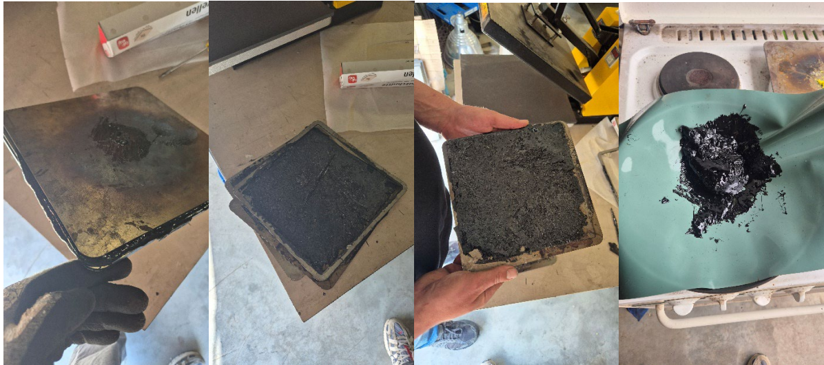
Figuur 12: Test 5 met PETG in stalen mal
