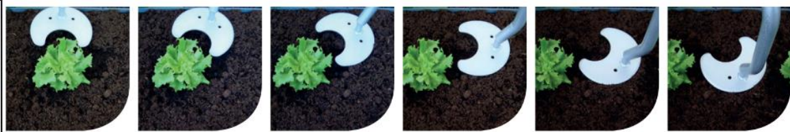
Figuur 14: Demonstratie van de roterende schoffelbladen van de Garford Robocrop inrow (Garford, sd)
