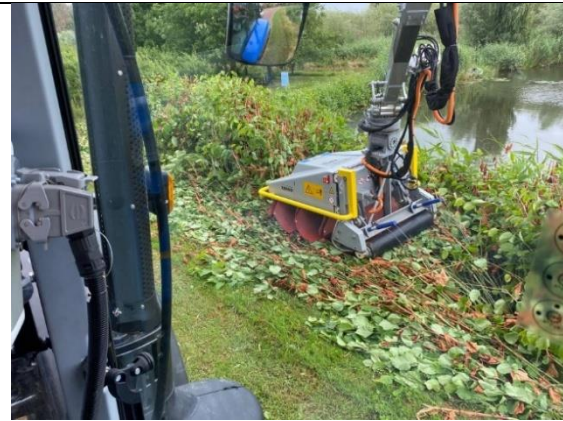
Figuur 57: Elektrische bestrijding Japanse duizendknoop (Exotenwacht)
