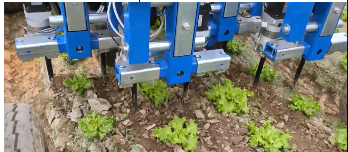
Figuur 21: Ingezoomd beeld van alle 4 de rijen die worden geschoffeld Ferrari Growtech, sd)
