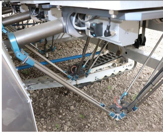
Figuur 45: Delta-arm die onkruid opzoekt en met verwarmingselement afdoodt (Stallen, 2022)
