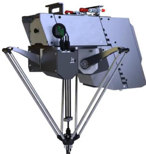
Figuur 47: Grijpmechanisme van Odd Bot Maverick (Odd Bot, sd)
