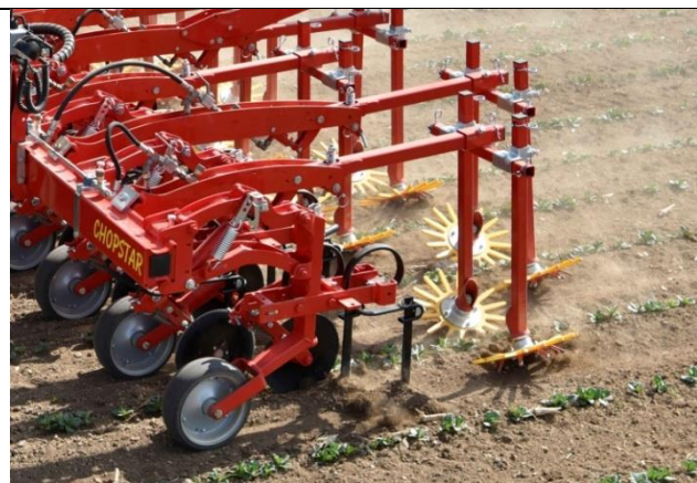
Figuur 34: Apart gemonteerde vingerwieders (Einböck Chopstar, sd)
