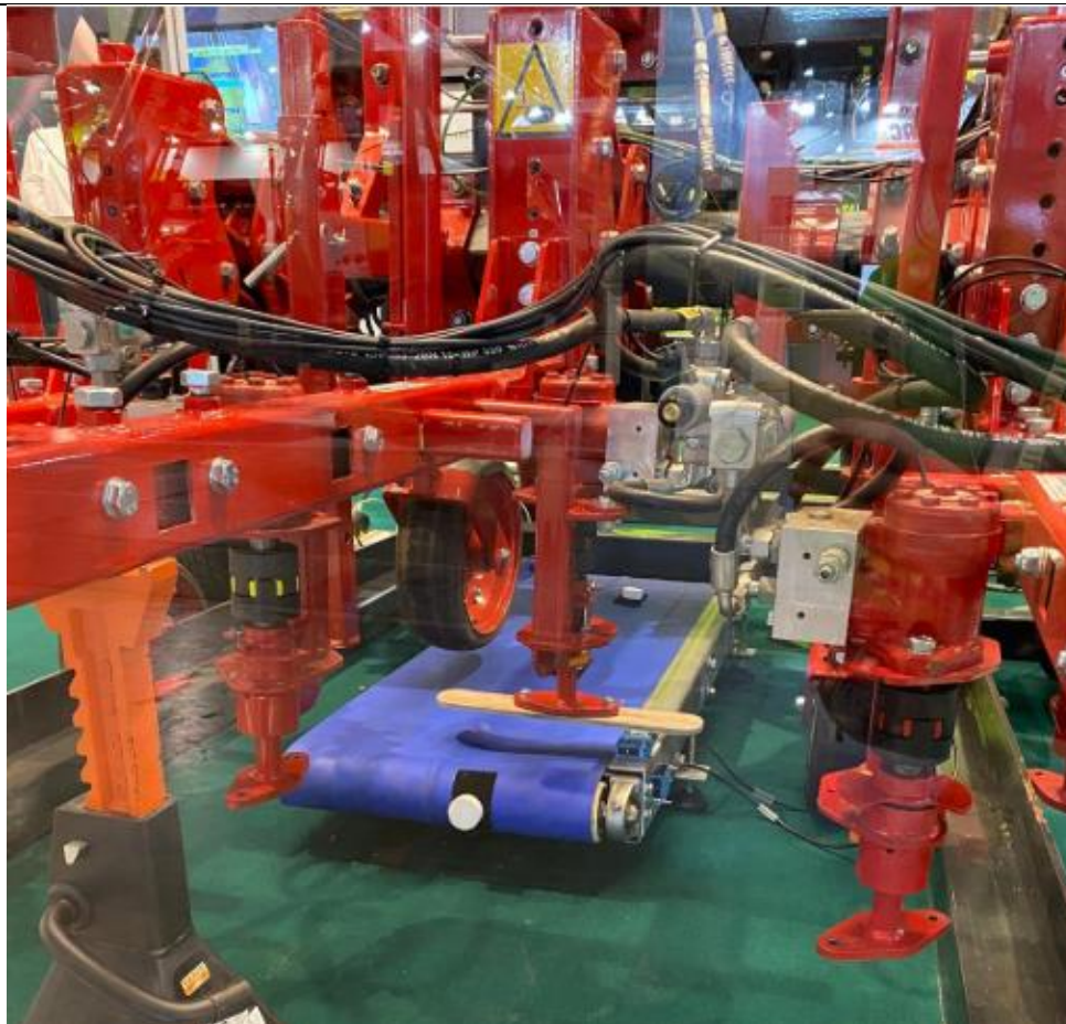
Figuur 25: Foto van het hydromotor mechanisme tijdens de voorstelling van hun prototype op Agribex 2025 (ILVO, sd)
