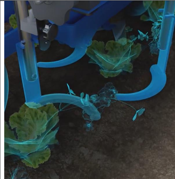
Figuur 10: Ingezoomd beeld van de sikkelvormige messen rond het gewas (Lemken, sd)
