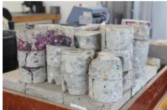
Afb. 58 Betonkern voor onderzoek (Nebest)
