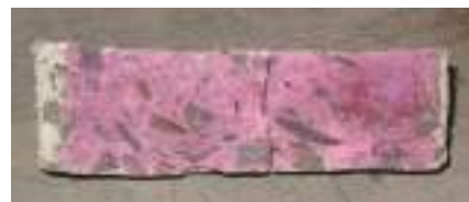
Afb. 21 Fenolftaleïne op een stuk beton gespoten (Buildwise- voorheen WTCB)
