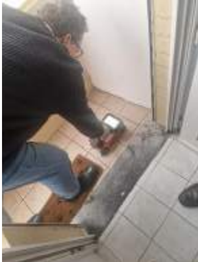
Afb. 55 Uitvoering dekkingsmeting (eigen foto)
