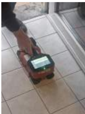
Afb. 28 Uitvoering dekkingsmeting (eigen foto)
