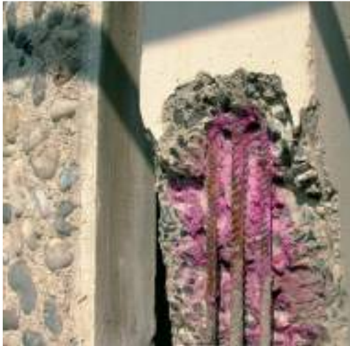
Afb. 23 Fenolftaleïne test (Buildwise – voorheen WTCB) Afb. 24 Destructie tot op niet gecarbonateerd beton (Joost Beke)
