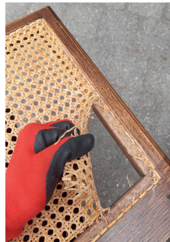
Figuur 66: Demontage van rotan vlechtwerk. Eigen afbeelding.
