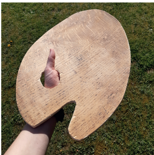
Figuur 95: Uitgesneden vorm van het schilderspalet, vervaardigd met een decoupeerzaag. Eigen afbeelding.
