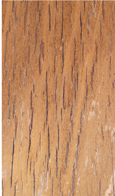
Figuur 23: Gecraqueleerde vernislaag op een stoelzitting. Bron: eigen afbeelding.
