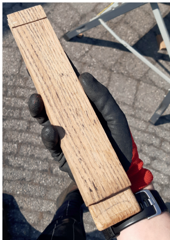
Figuur 65: Pen-en-gatverbinding in oorspronkelijke toestand. Eigen afbeelding.
