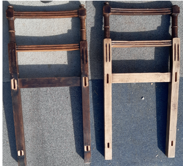
Figuur 98: Verschil donkergebeitst eikenhout, voor en na het schuren. Eigen afbeelding.
