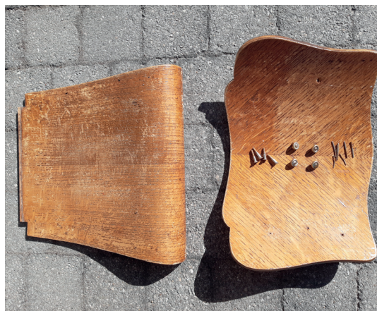
Figuur 63: Overzicht van stoelzitting en rugleuning met demontagesporen van nagels en schroeven. Eigen afbeelding.
