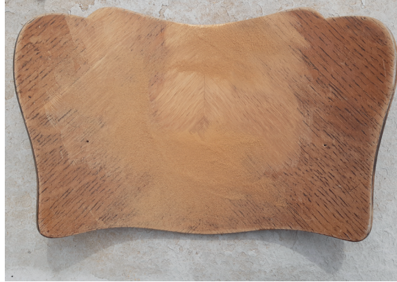
Figuur 86: Rugleuning tijdens het verwijderen van de oude vernislaag. Eigen afbeelding.
