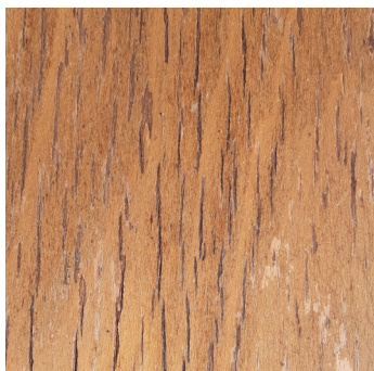
Figuur 70: Gecraqueleerde vernislaag. Eigen afbeelding.
