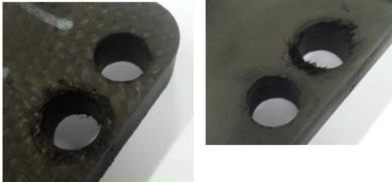
Figuur 43: Doorgevonkt gat met optimale vonktechnologieën, bovenzijde (links), onderzijde (rechts)
