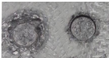
Figuur 40: Macroscopische weergave van experimenten, sample oppervlak bij 65 A - 6,4 \mu s (links) en bij 65 A - 12,8 \mu s (rechts)
