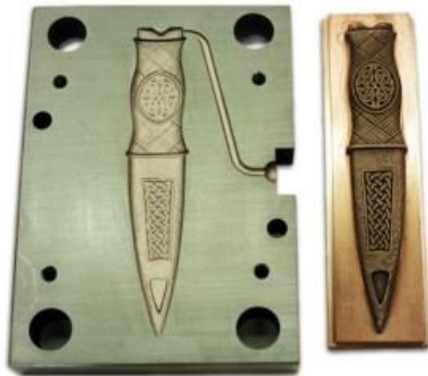
Figuur 2: Werkstuk en elektrode van een zinkvonkmachine [28]
