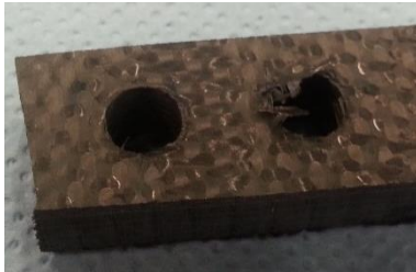
Figuur 34: Delaminatie van een geboord gat, bovenzijde boring (links), onderzijde boring (rechts)
