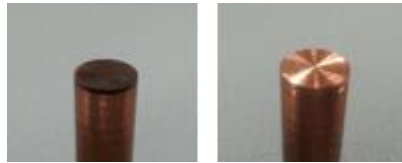
Figuur 31: Vervuilde elektrode (links) gereinigde elektrode (rechts)
