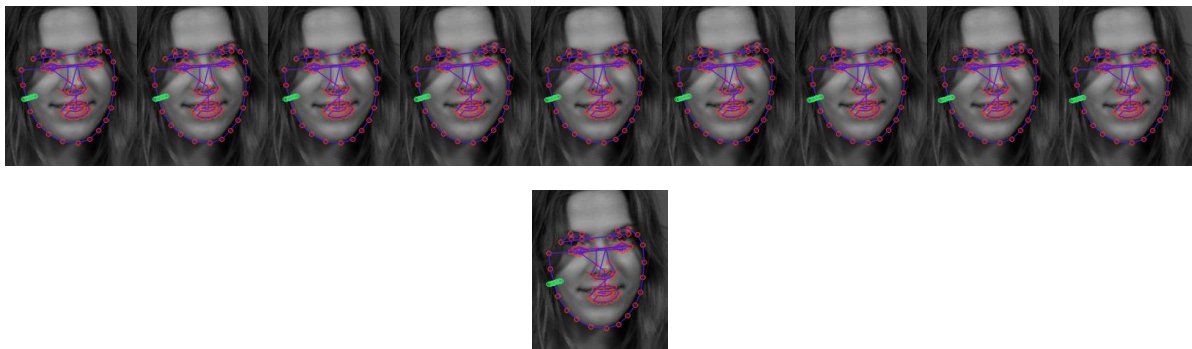
Figuur 4.9: Whisker op piramideniveau 0 (meest detail) met onderaan de optimale whisker met kleinste Mahalanobis-afstand.
