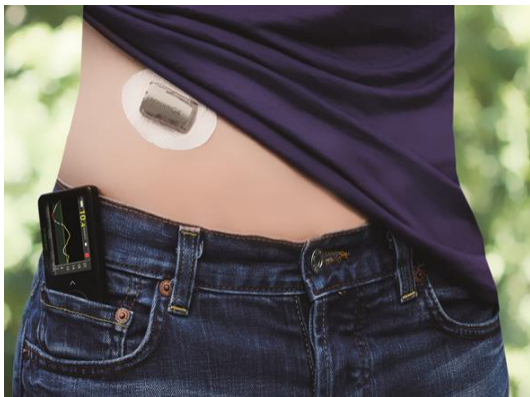
Figuur 12: voorbeeld van een CGM (met behulp van het Dexcom G4 Platinum systeem)
