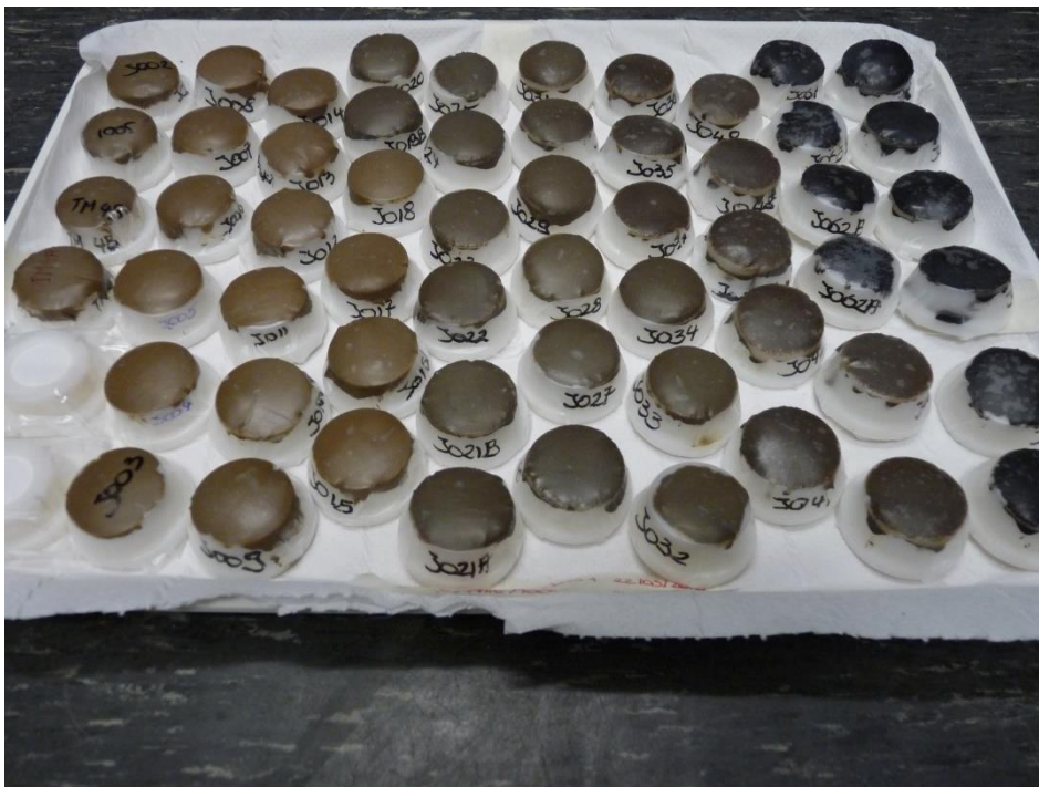
Figuur 4.1: DGT-eenheden met bodemstalen afgedekt met parafilm.
