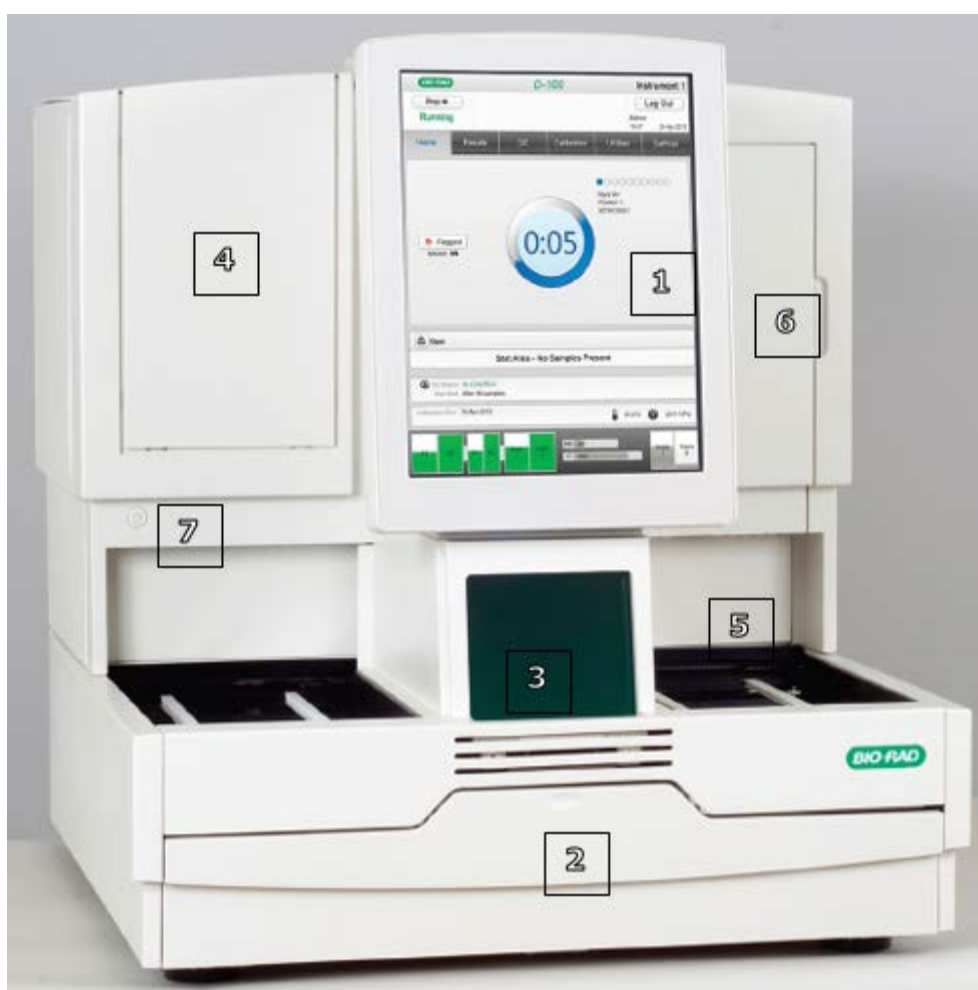
Figuur 16: Bio-Rad D-100-opstelling: 1: touchscreen, 2: reagentia, 3: STAT-positie, 4: optioneel printer, 5: invoer rek met stalen, 6: kolom/pre-filter, 7: aan-knop
