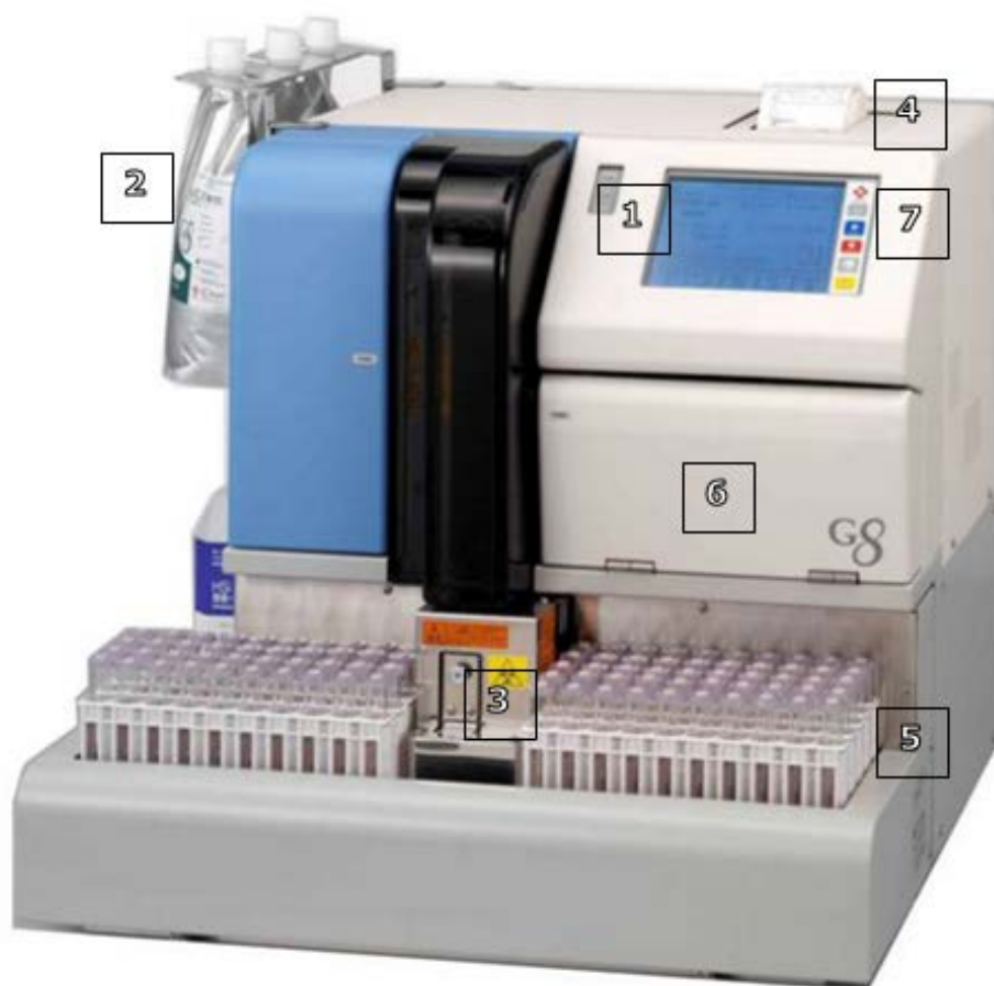
Figuur 18: Tosoh G8-opstelling; 1: touchscreen, 2: reagentia, 3: STAT-positie, 4: printer, 5: invoer rek met stalen, 6: kolom/prefilter, 7: aan-knop
