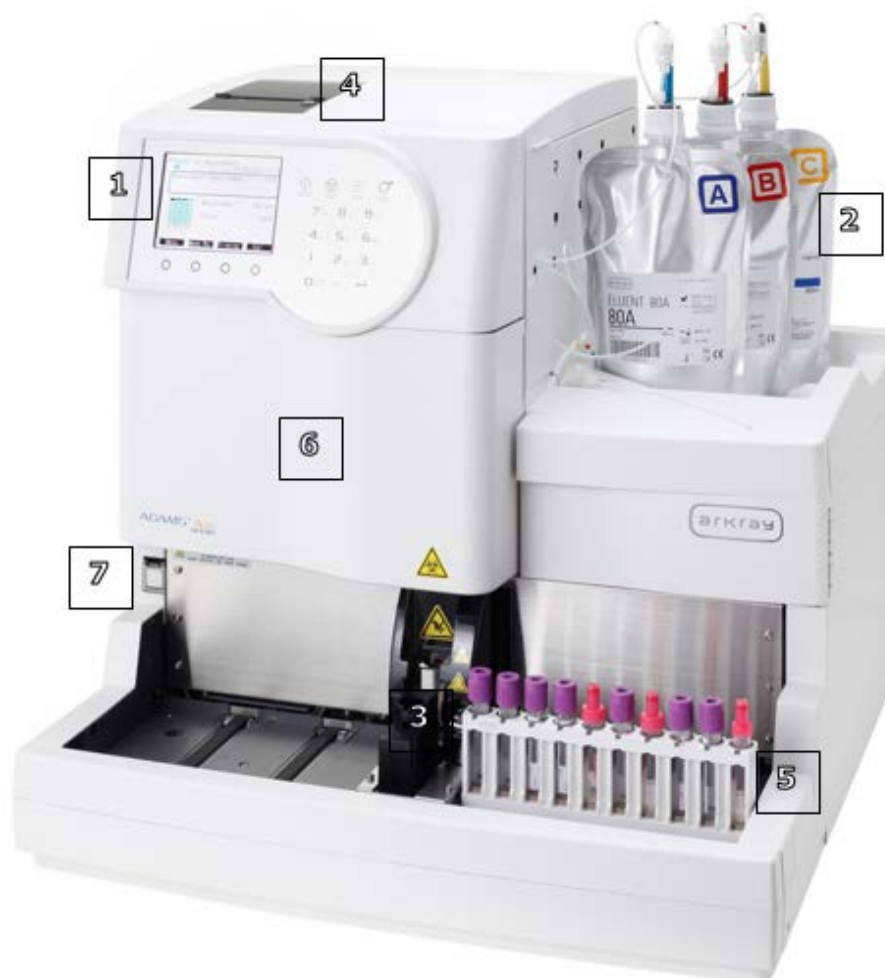
Figuur 14: Menarini HA-8180V-opstelling; 1: LCD-scherm, 2: reagentia, 3: STAT-positie, 4: printer, 5: invoer rek met stalen, 6: kolom/pre-filter, 7: aan-knop
