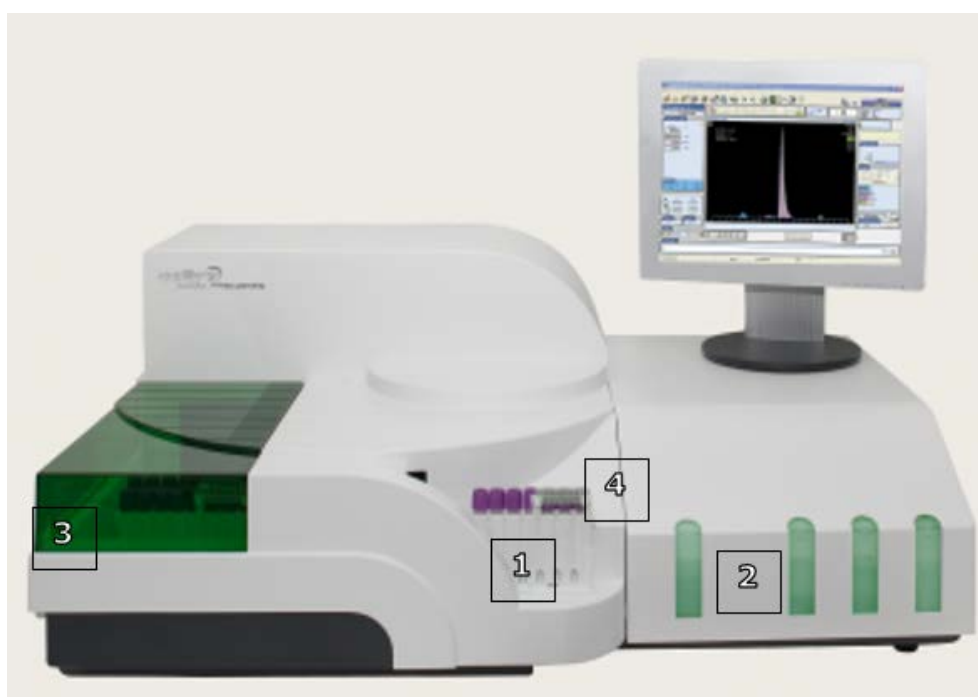
Figuur 20: Sebia capillarys 2 flex piercing-opstelling; 1: invoer rek met stalen, 2: reagentia, 3: rek met stalen na bepaling, 4: indicator ready
