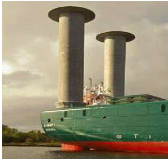
Figuur 1: Flettner rotor op ENERCON E-schip 1
