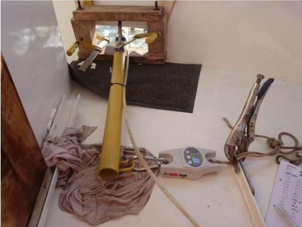
Figuur 64: Overzicht opstelling aan boord met dynamometer
