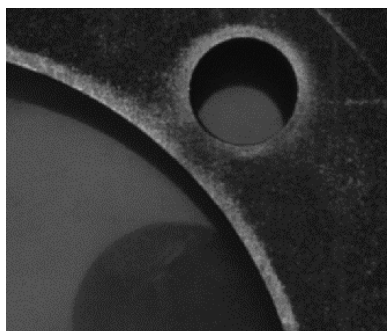
Figuur 52: Onvoldoende belichte gaten
